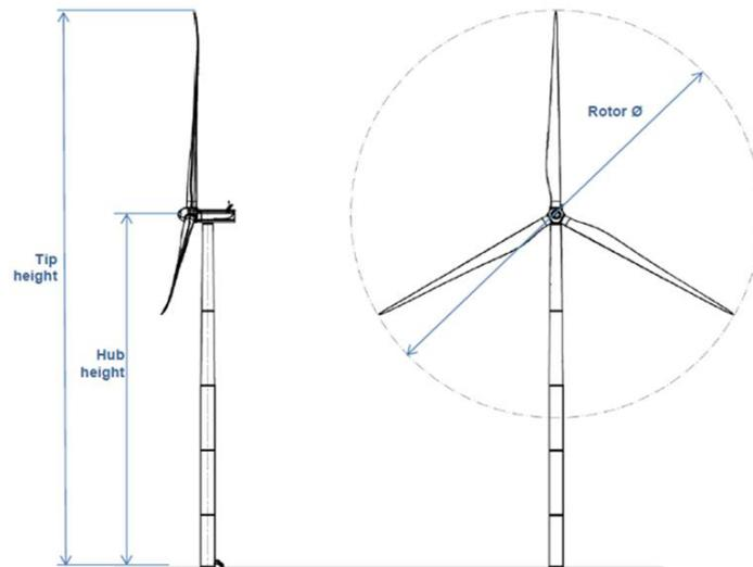
**Figura 3-3: Vista e caratteristiche di un aerogeneratore da 6,0 MW**
