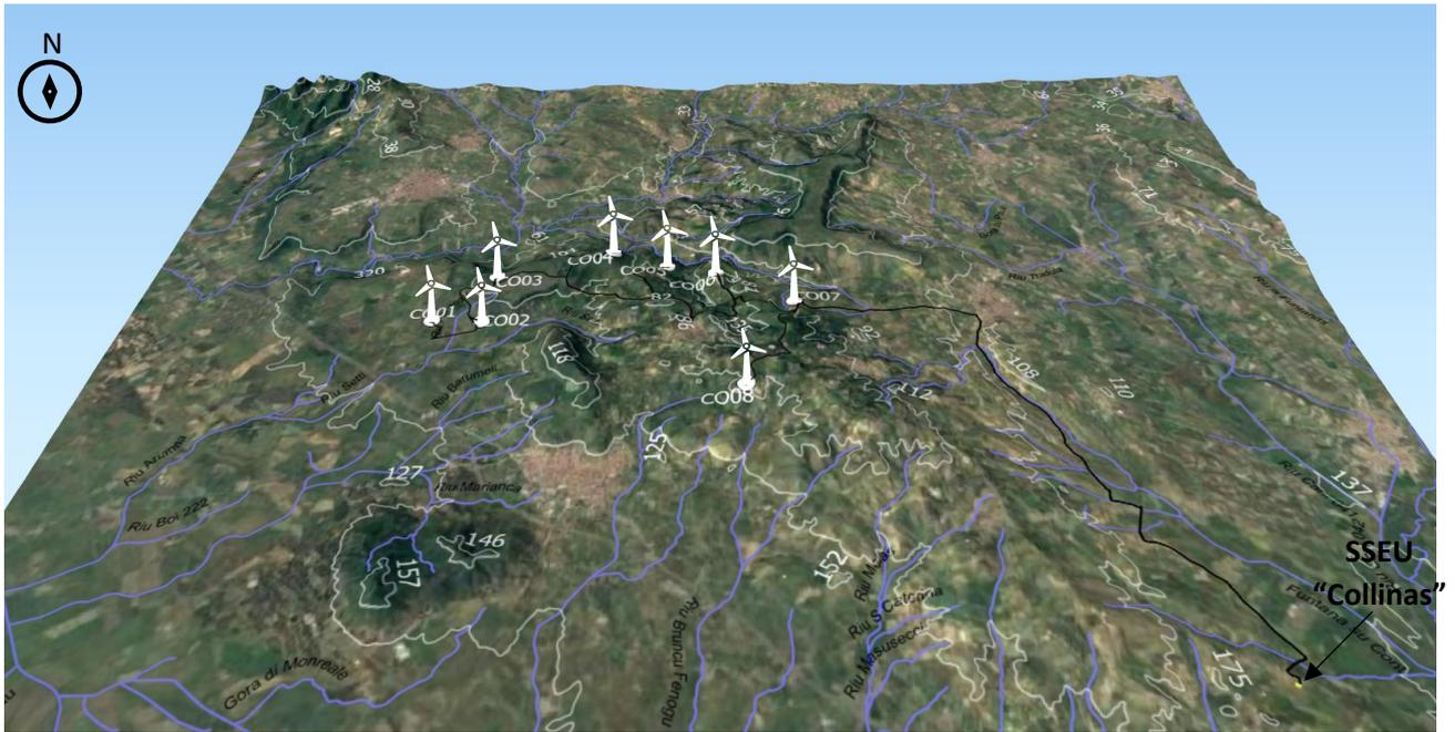
Figura 5-1: inquadramento geomorfologico dell'areale dell'impianto con indicazione del reticolo idrico, delle quote dei rilievi e del tracciato di connessione (in nero) e della SSEU (in giallo)
