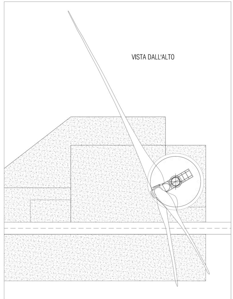
Nota: Le dimensioni riportate sono relative ad un modello generico di turbina di grande taglia. In base al modello di aerogeneratore selezionato in fase esecutiva, tali dimensioni potranno variare rispettando comunque l'altezza complessiva massima di 210 m (diametro del rotore, massimo 170 m; altezza al mozzo, massimo 125 m).
