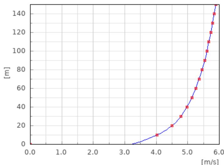
Figura 2-3: variazione della velocità del vento in funzione dell'altezza
