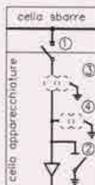
SCHEMA ELETTRICO DELLO SCOMPARTO
