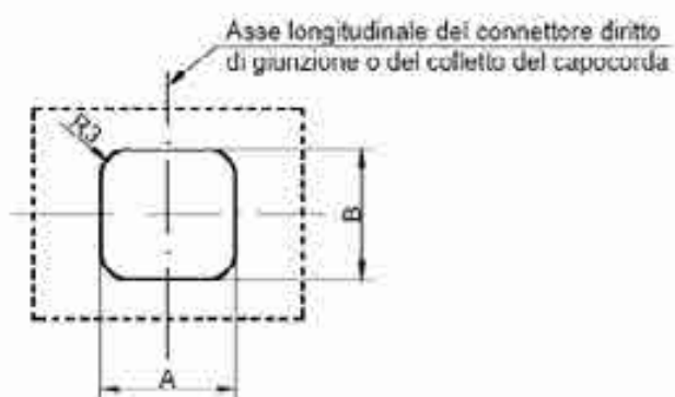
Fig. 3 Matrice e punzone per connettore per collegamento a terra dello schermo a fili del cavo estruso.
