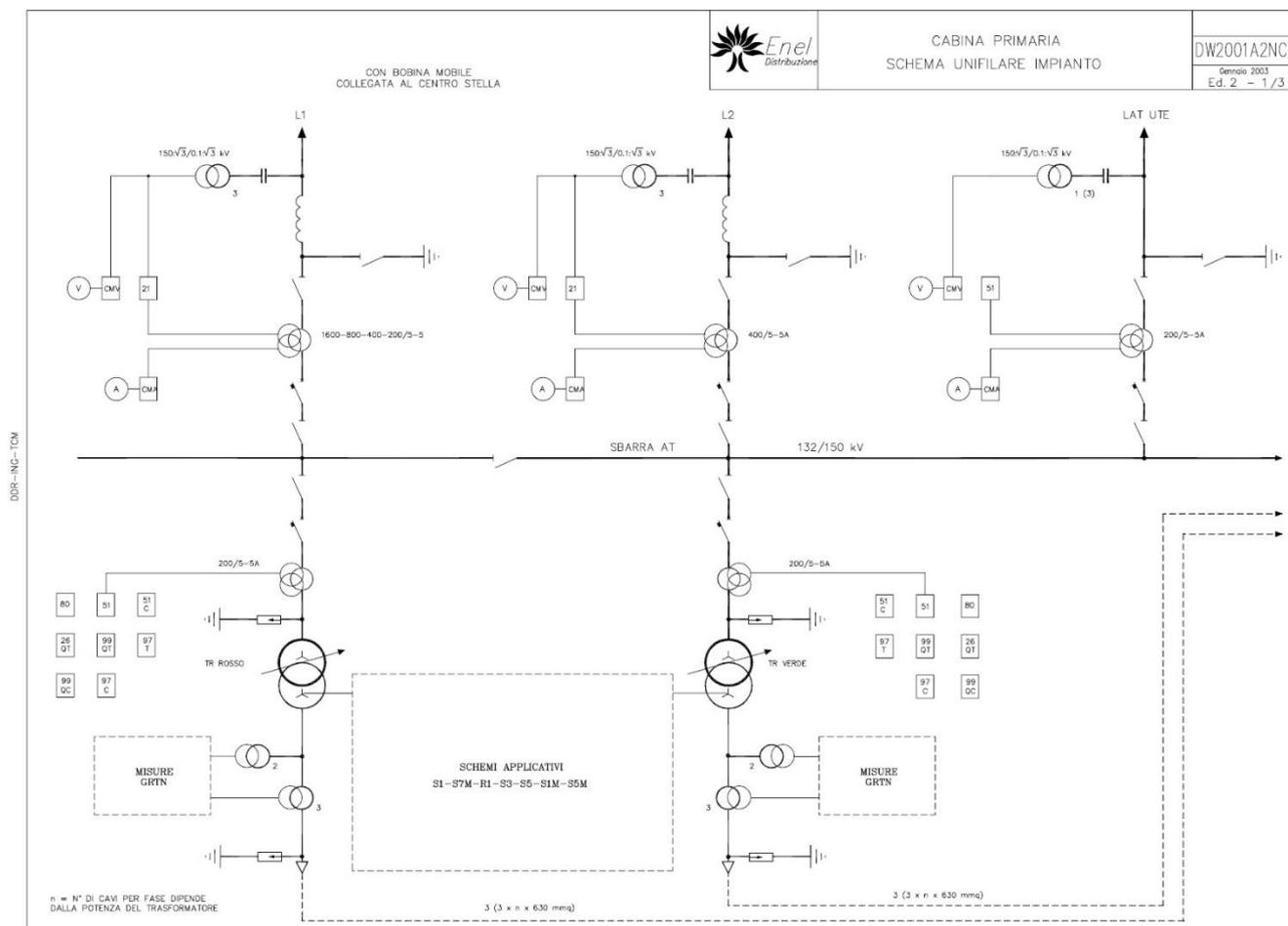
Figura 1 - Schema unifilare sezione AT di CP generico
