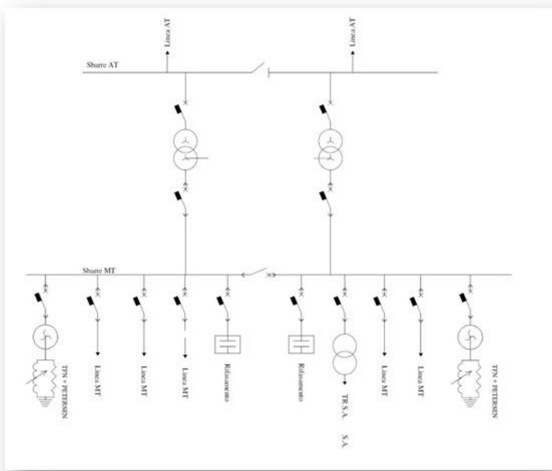
Figura 2 - integrazione schema unifilare fig. 4 particolari ASC lato MT per CP a neutro compensato su sbarra MT
