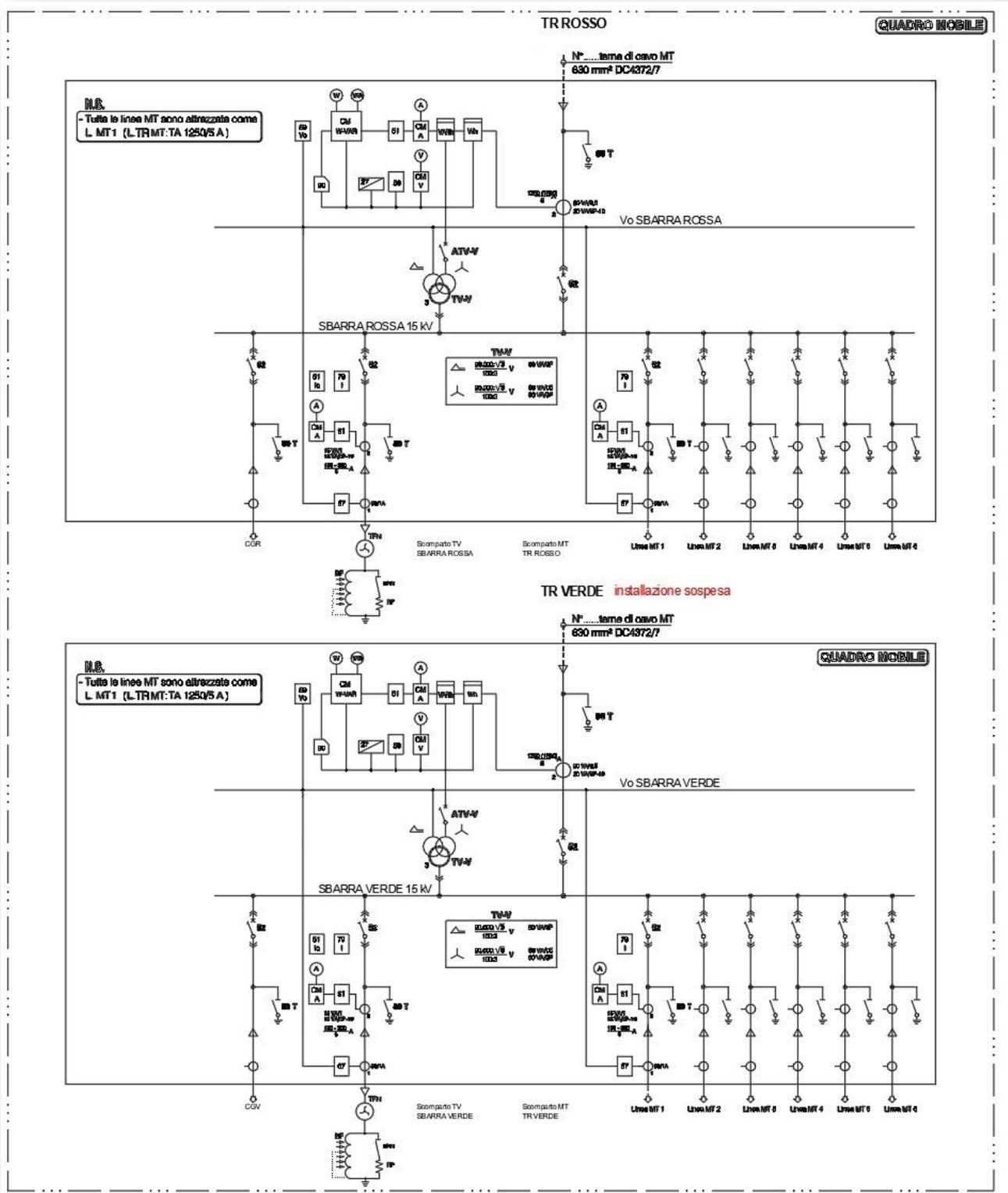
Figura 3 - integrazione schema unifilare fig. 2 DY 770/2 particolari ASC lato MT per neutro compensato su sbarra MT
