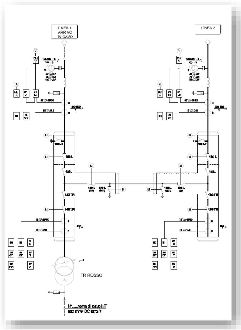
Figura 2 - Schema unifilare sezione AT di CP Pabillonis ibrido
