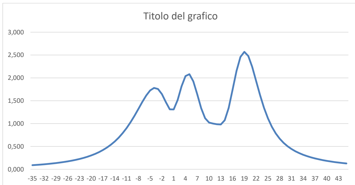
Figura 10 Profilo laterale E [kV/m] corridoio condiviso ampiezza 14 m uscita/ingresso CP Arcidano altezza da terra y = 1m
