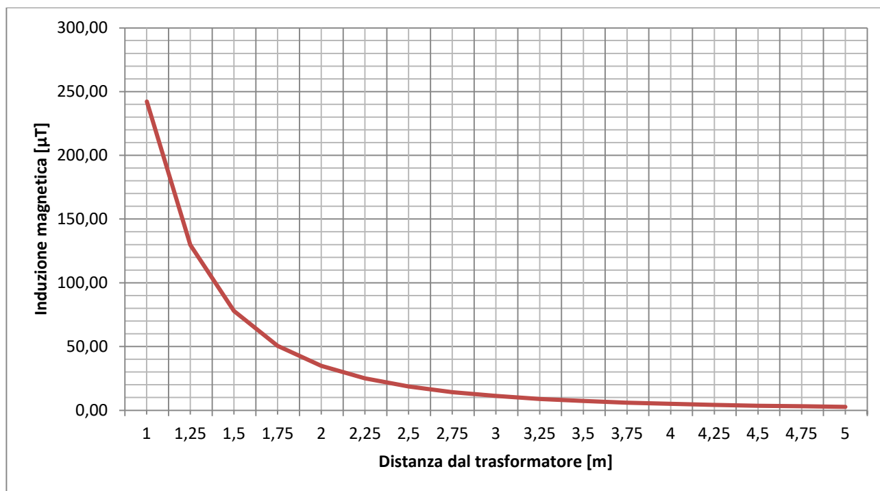
Figura 1. Andamento dell'induzione magnetica con la distanza dal trasformatore
