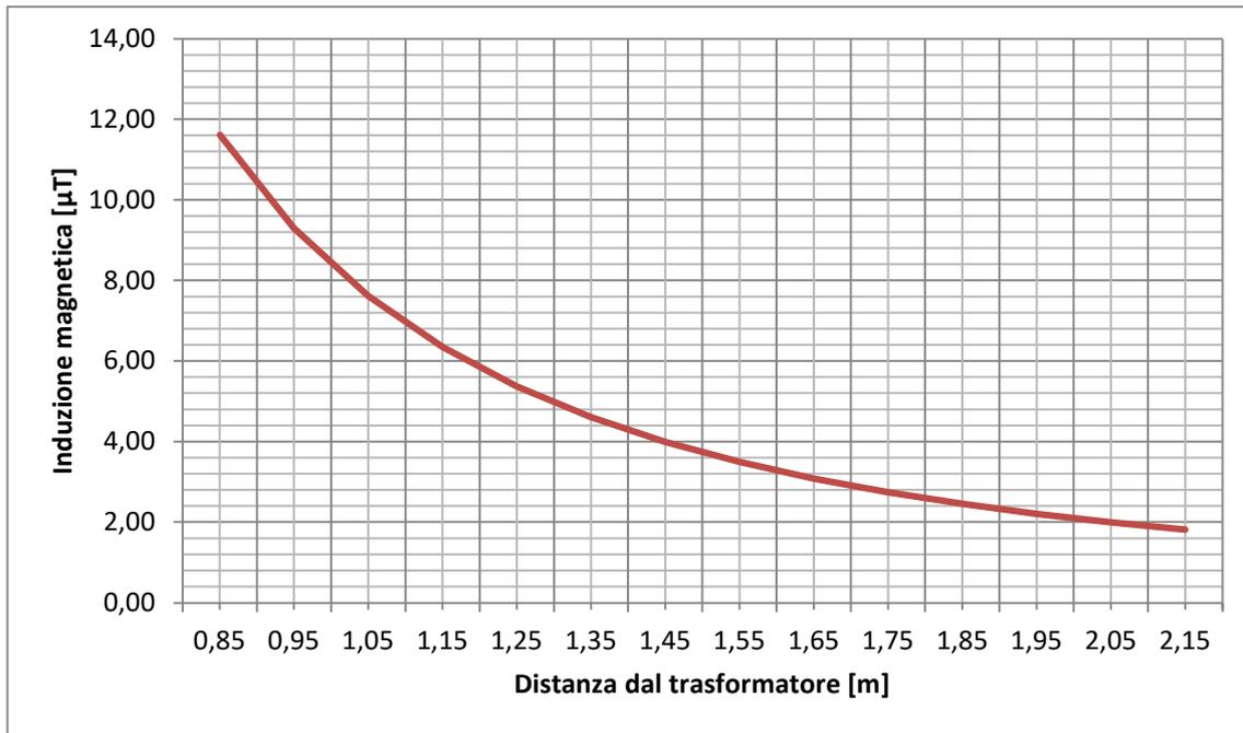
Figura 5. Andamento dell'induzione magnetica con la distanza dal cavidotto MT
