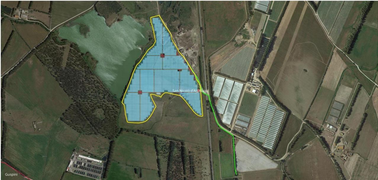
Fig.2: impianto in progetto su ortofoto, area progetto (giallo) con campi fotovoltaici (azzurro) e cavidotto (verde)
