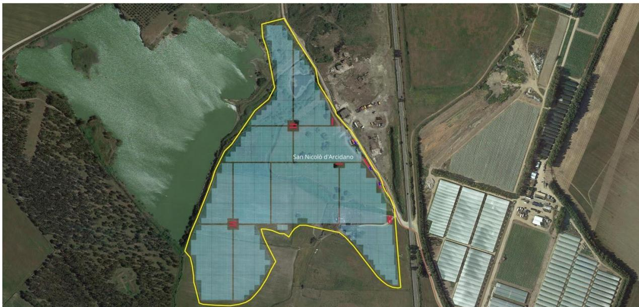
Fig.3: area impianto con cabine elettriche (in rosso)
