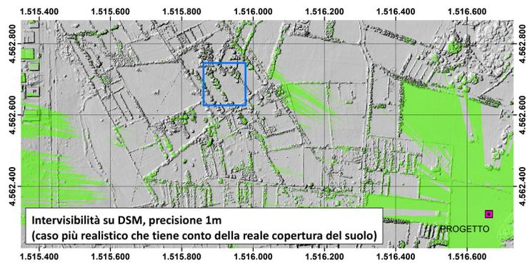
Intervisibilità su DSM, precisione 1m (caso più realistico che tiene conto della reale copertura del suolo)
