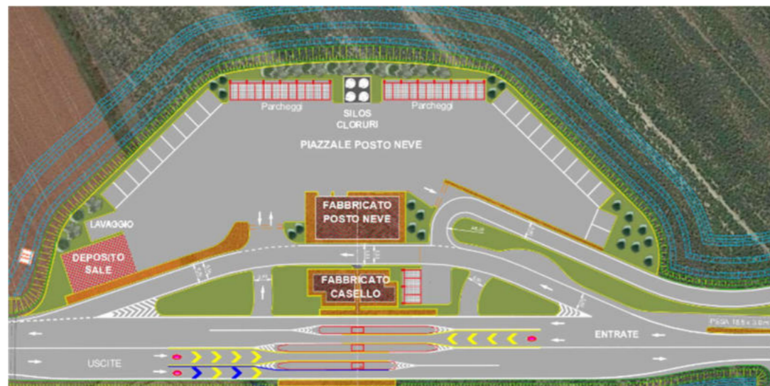
Figura 6-13 Stazione di pedaggio - Pianta generale
