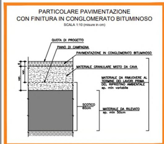
Figura 2-4 Dettaglio dell'area di cantiere e della relativa pavimentazione (da CNT0211)
