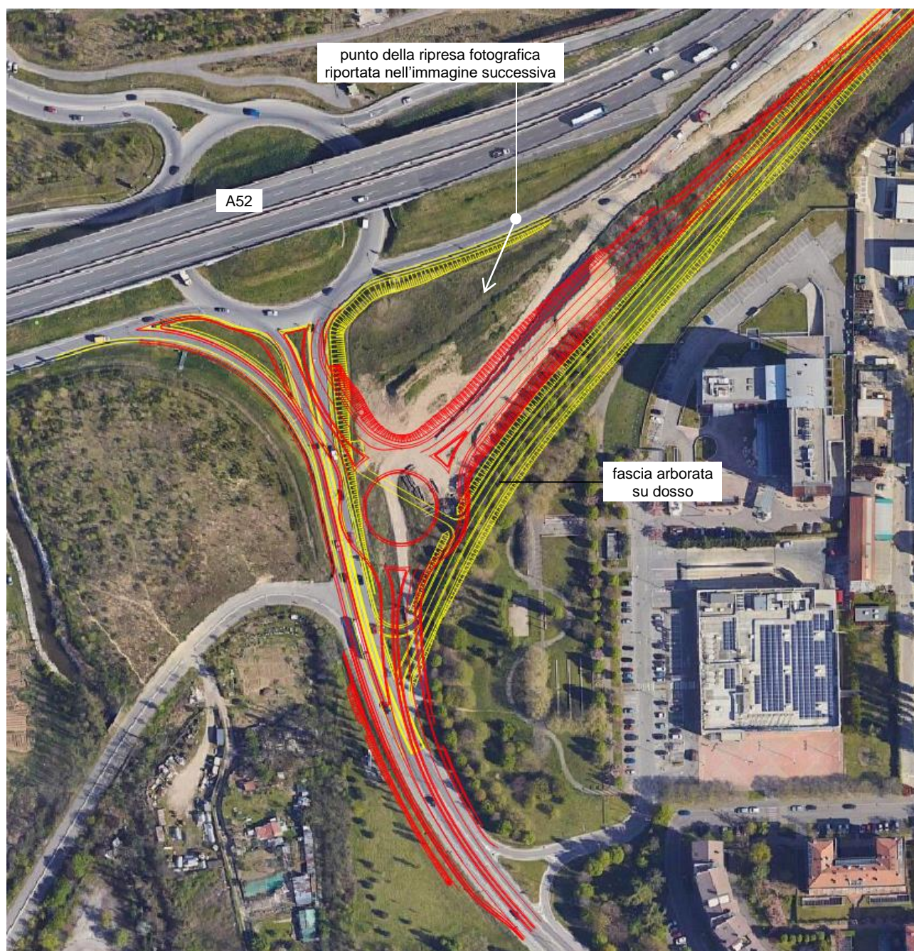
Figura 2.5 – Sovrapposizione delle due soluzioni progettuali (in giallo il Prog. Preliminare, in rosso il Prog. Definitivo)
