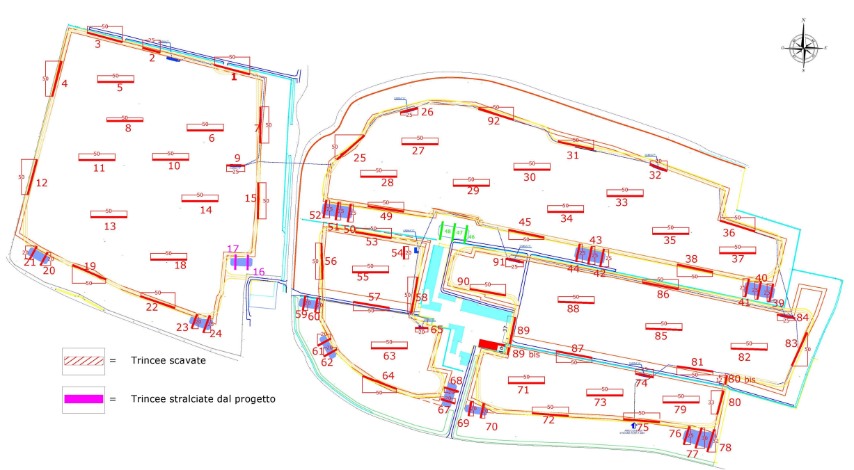
Fig.4- IL posizionamento delle trincee eseguite in rosso e l'edificio esistente in ciano.
