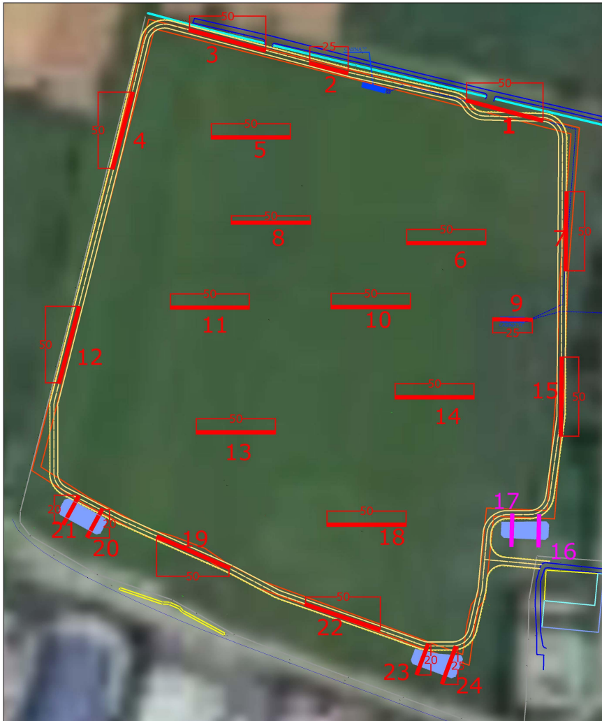
Fig.6- Posizionamento delle trincee zona 1
