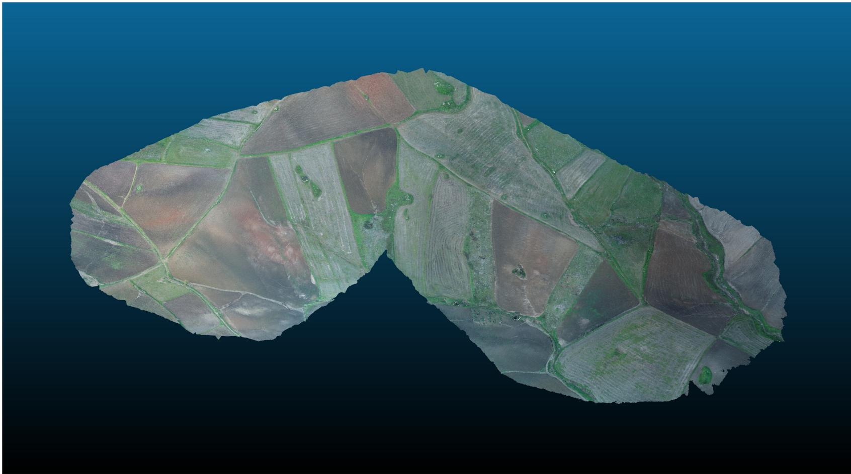
NUVOLO DI PUNTI DA RILIEVO DRONE
