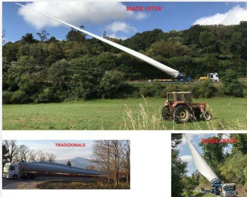
Figura 33 - esempi di trasporto tradizionale e soluzione con cambio della configurazione di carico durante il percorso (blade lifter)
