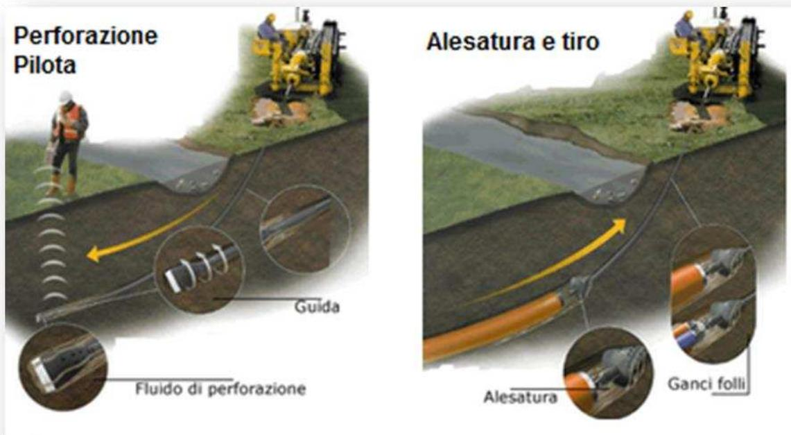
Figura 50 - Tecnologia di trivellazione orizzontale controllata (TOC)
