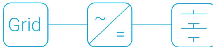
*Figura 29 - Schema semplificato di un convertitore monostadio*
