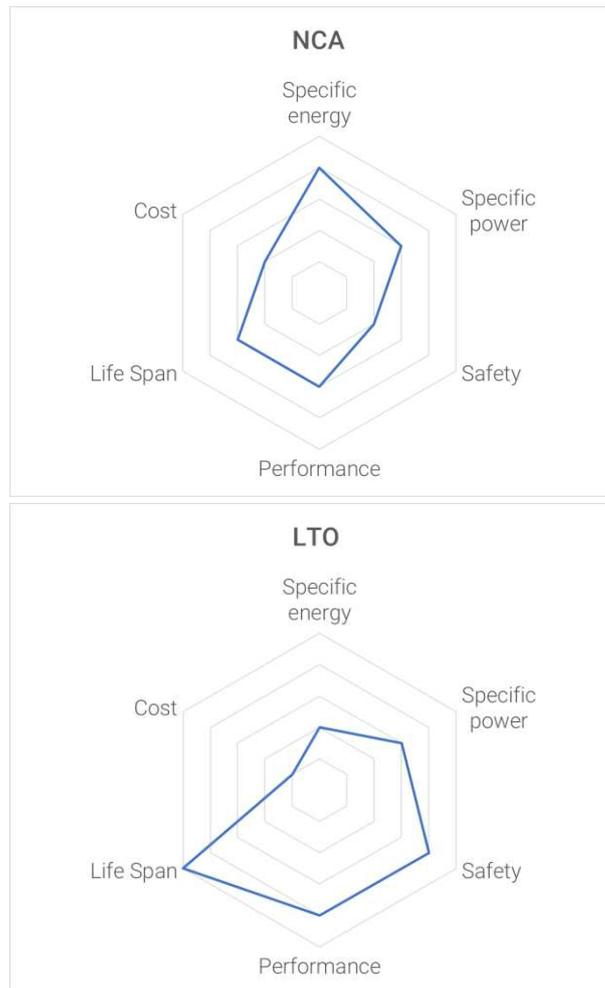
**Figura 24 - Caratteristiche tecnologie litio**
