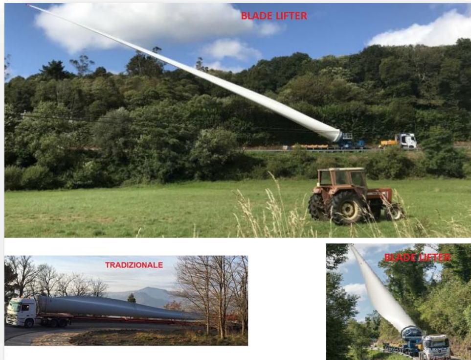
Figura 20 – esempi di trasporto tradizionale e soluzione con cambio della configurazione di carico durante il percorso (blade lifter)
