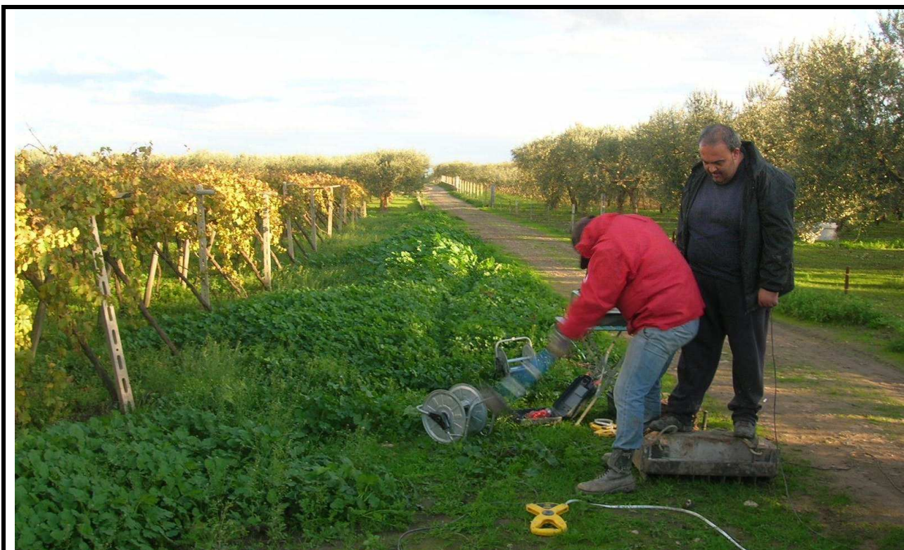
[particolare dell'esecuzione di una battuta in onde S nel punto di scoppio E della Base Sismica B.5.1]
