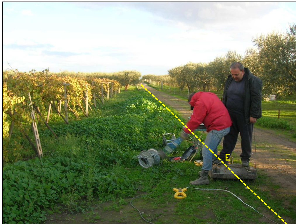
Foto 4: Postazione ed allineamento della Base Sismica B.S.1 - particolare dell'esecuzione di una battuta in onde S nel punto di scoppio E -
