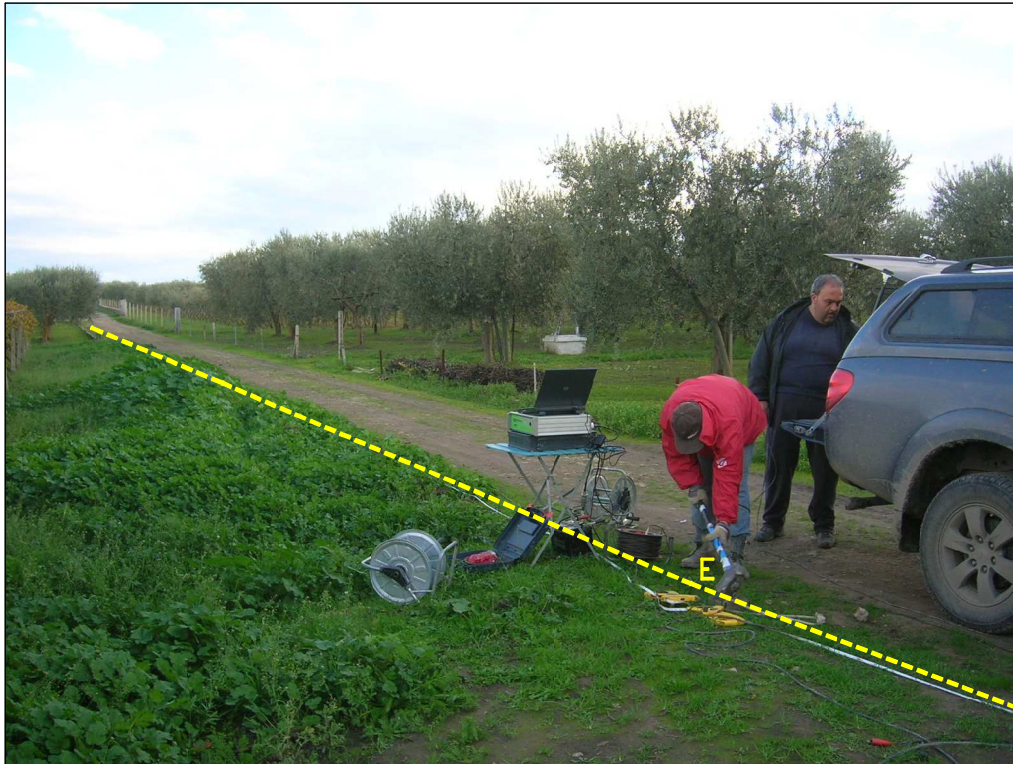
Foto 3: Postazione ed allineamento della Base Sismica B.S.1 - particolare dell'esecuzione di una battuta in onde P nel punto di scoppio E -
