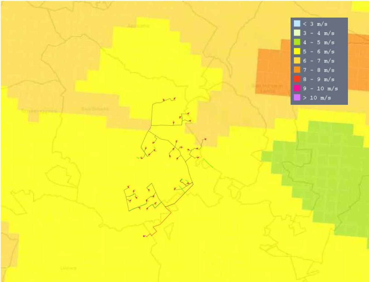
Impianto su Atlante eolico interattivo con velocità media annua del vento a 150 m s.l.m.
