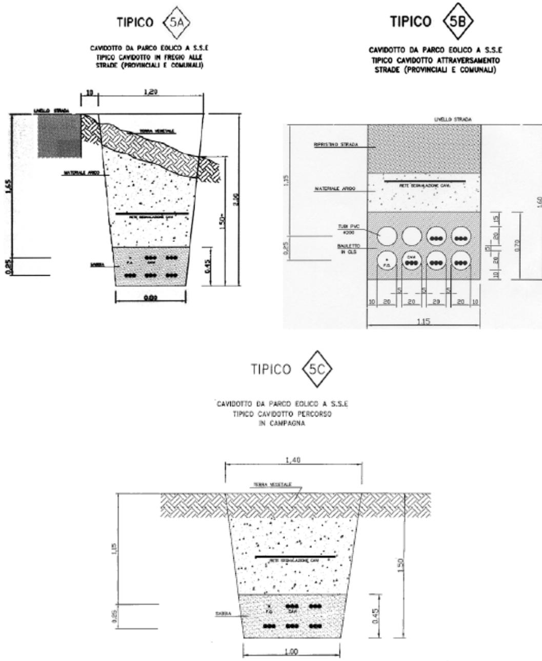
I cavi di potenza sono terne unipolari del tipo ARG7H1(AR)E-AIR-BAG in alluminio sezioni da 185 a 400mmq ed idonei anche alla posa direttamente interrati senza protezione meccanica in conformità alla modalità di posa "L" figura 3.6 e punto 4.3.11 della norma CEI 11-17 Fascicolo 8402.
