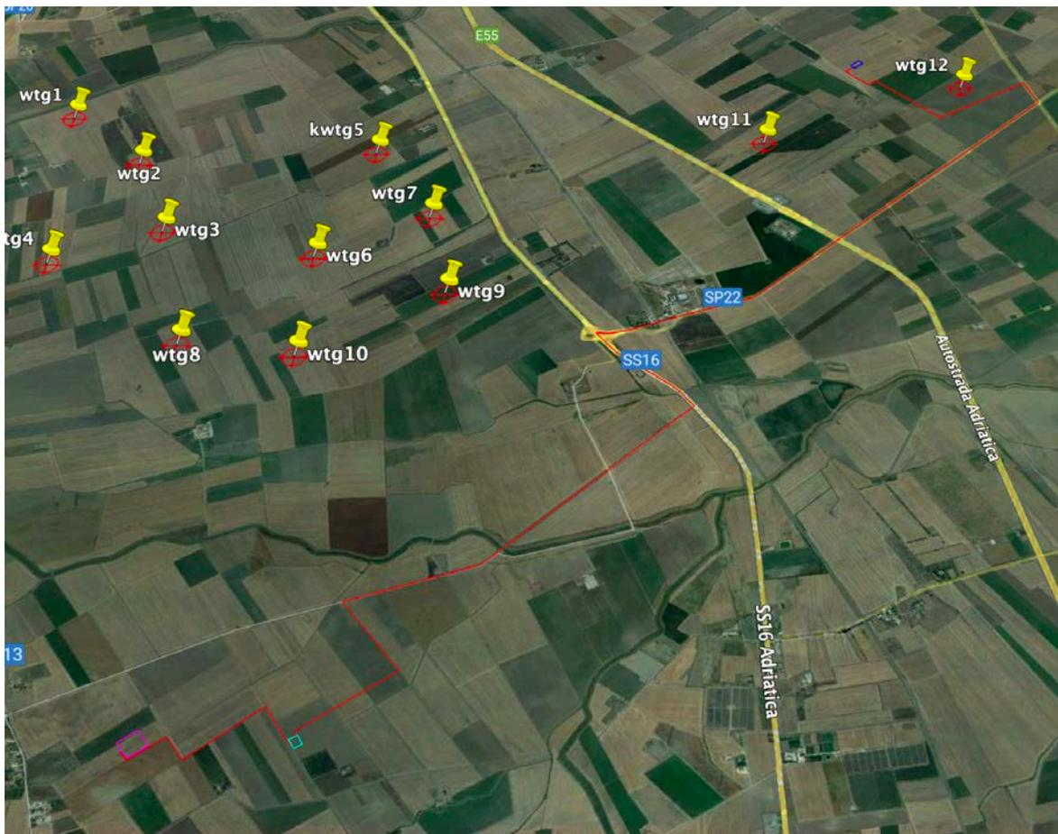
Per garantire una sufficiente elasticità ed indipendenza di esercizio, gli aerogeneratori sono collegati con cavi elettrici separati, garantendo così una continuità di servizio indipendente anche durante il fuori esercizio di uno solo per esigenze di manutenzione.
