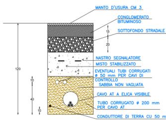
C2 - SEZIONE CAVIDOTTO A DUE TERNE DI CAVI
