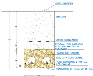
C3 - SEZIONE CAVIDOTTO A TRE TERNE DI CAVI
