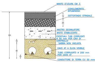
C3 - SEZIONE CAVIDOTTO A TRE TERNE DI CAVI
