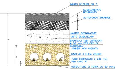
C4 - SEZIONE CAVIDOTTO A QUATTRO TERNE DI CAVI
