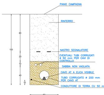
C2 - SEZIONE CAVIDOTTO A DUE TERNE DI CAVI
