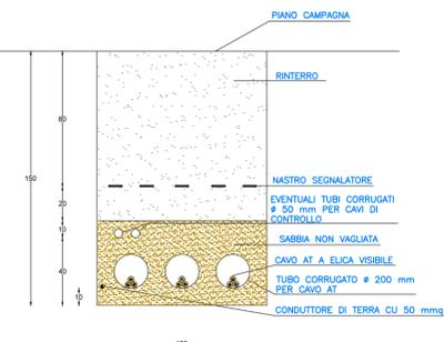
C4 - SEZIONE CAVIDOTTO A QUATTRO TERNE DI CAVI
