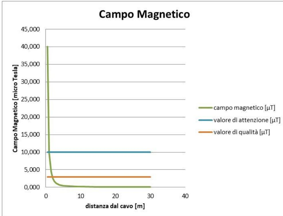
Si può concludere che il campo elettromagnetico complessivo post operam presenterà ad altezza d'uomo e nel punto di maggiore intensità un valore massimo inferiore al più stringente limite di normativa ( $3 \mu\text{T} > 1,982 \mu\text{T}$ ).
