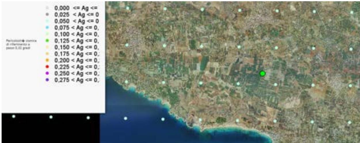
Dettaglio pericolosità sismica area Aerogeneratori
