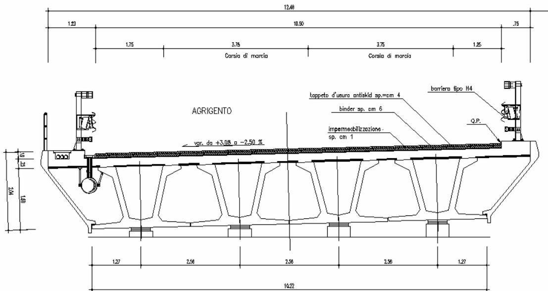
Le travi prefabbricate sono predisposte con un'armatura atta a resistere allo scorrimento trave-soletta al fine di costituire, a getto della soletta dell'impalcato avvenuto, una sezione reagente comprendente anche la soletta stessa.
