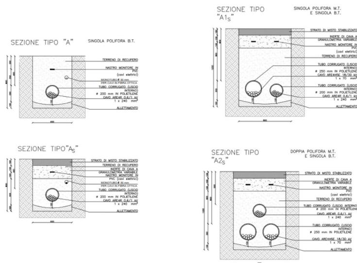
Figura 5 - Sezioni tipo scavi cavidotti
