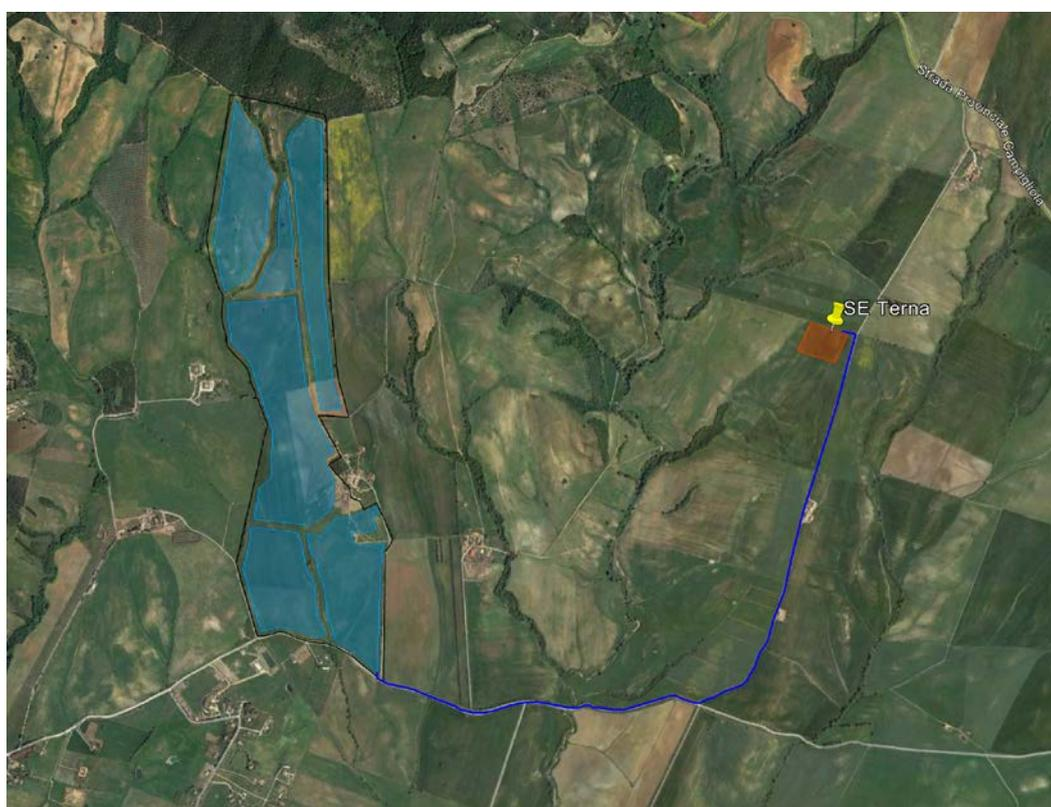
Fig. 3– Tracciato cavidotto MT verso SE
