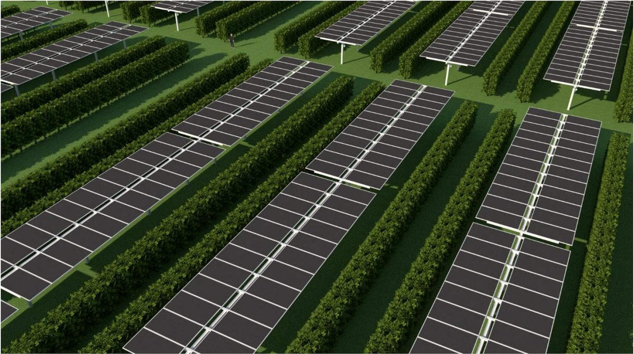
*Figura 3- Schizzo dell'assetto impiantistico: un filare FV e due siepi ulivicole alternate*
