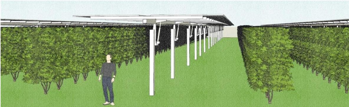
*Figura 131 - Esempio con pannelli orizzontali*
