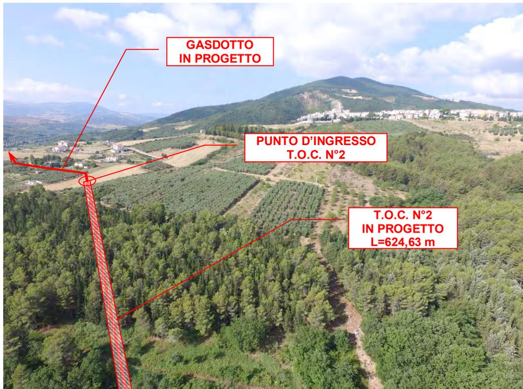
Foto n°8 – Vista panoramica attraversamento in destra idraulica del *Torrente Cervaro* con Trivellazione Orizzontale Controllata (T.O.C. N°2). Vista del punto di ingresso della trivellazione e attraversamento *Strada Comunale Guardalfiera Contini Palata*.
