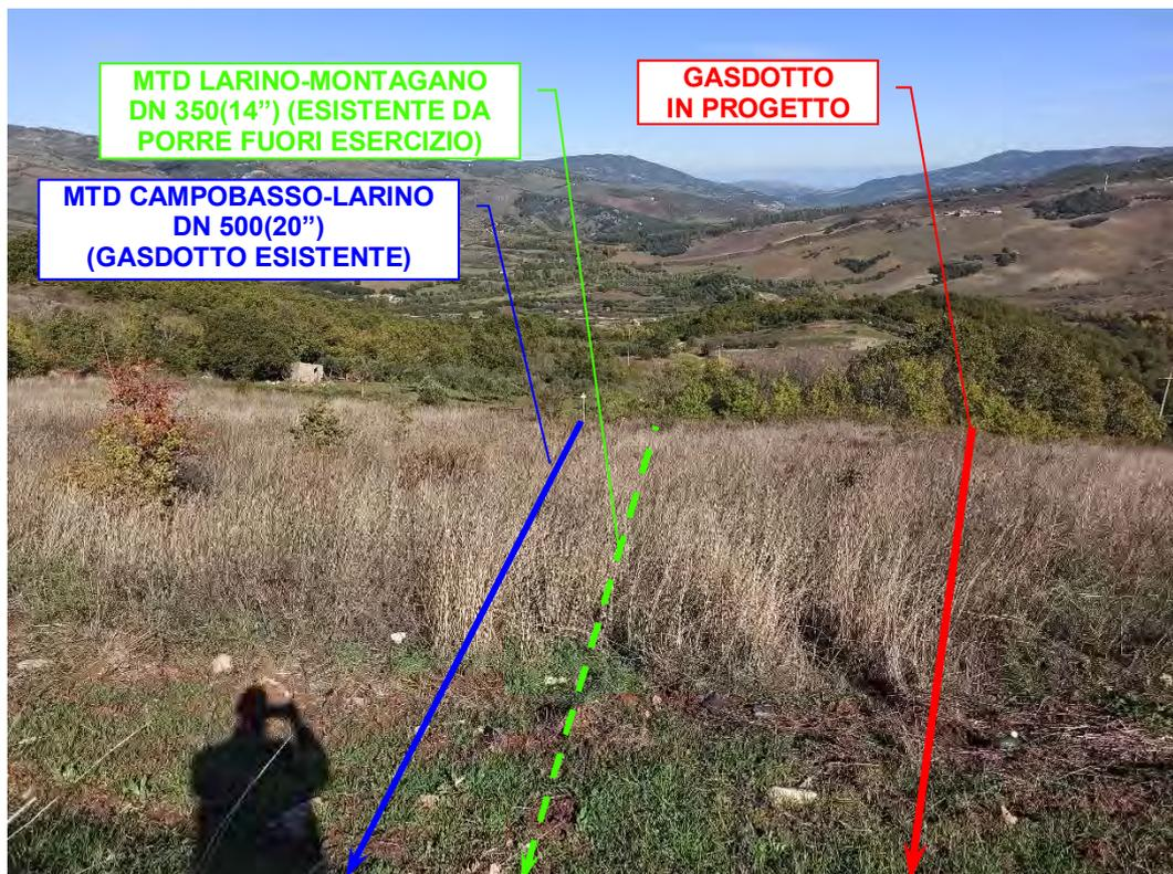
**Foto n°71** – Vista panoramica gasdotto in dismissione (tratto verde), in progetto (tratto rosso) e in parallelismo con il gasdotto esistente (tratto blu).
