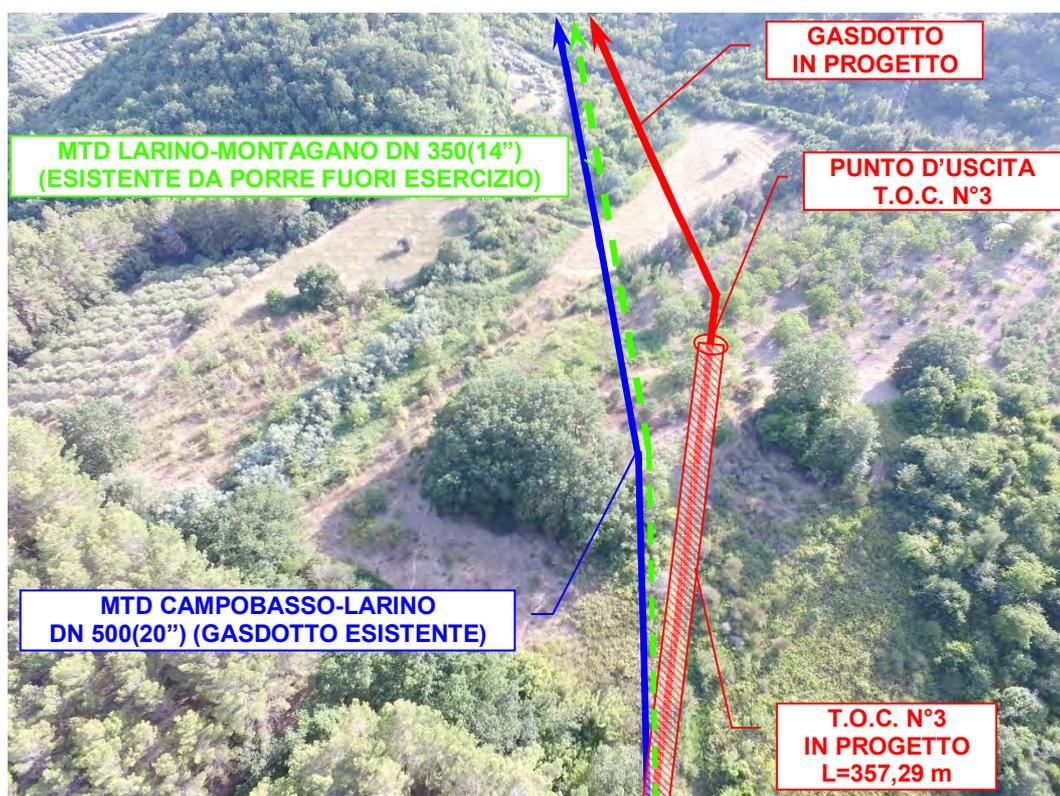
Foto n°18 – Vista panoramica punto d'uscita Trivellazione Orizzontale Controllata N°3.
