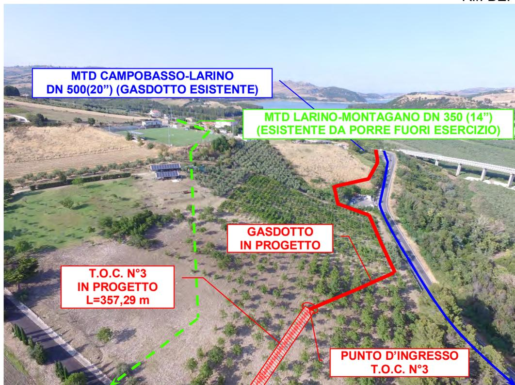
**Foto n°15** – Vista panoramica dell'interferenza del gasdotto in progetto con un vigneto e un noceto, all'interno dell'agriturismo *Il Casale di Clesilde* e ingresso Trivellazione Orizzontale Controllata (T.O.C. N°3).
