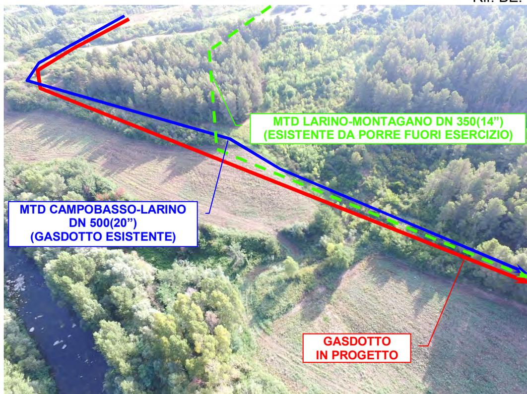
**Foto n°56** – Vista panoramica gasdotti in parallelismo e attraversamento del *Vallone D'Aino* e della strada (identificata catastalmente) come *Strada Vicinale Sferracavallo*.
