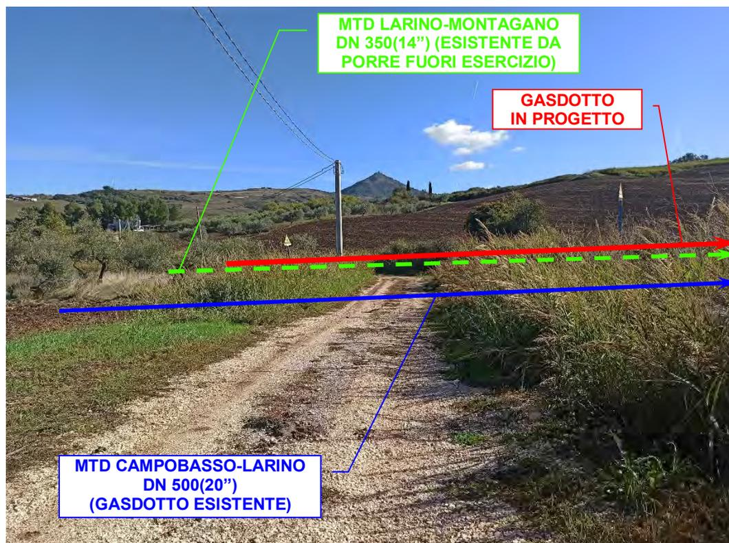
Foto n°67 – Attraversamento con scavo a cielo aperto della *Strada Comunale via Ischia* (sterrata).
