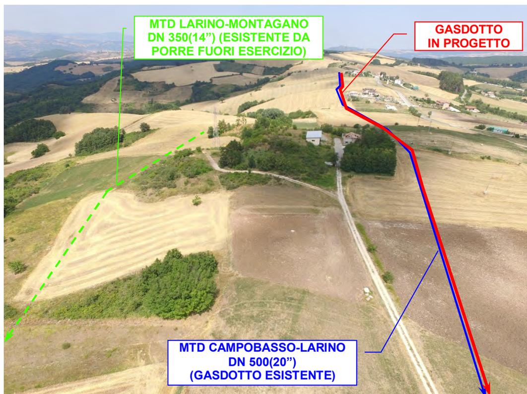
**Foto n°105** – Vista panoramica gasdotto in dismissione (tratto verde), in progetto (tratto rosso) e in parallelismo con il gasdotto esistente (tratto blu), in località *Colle Impiso*.
