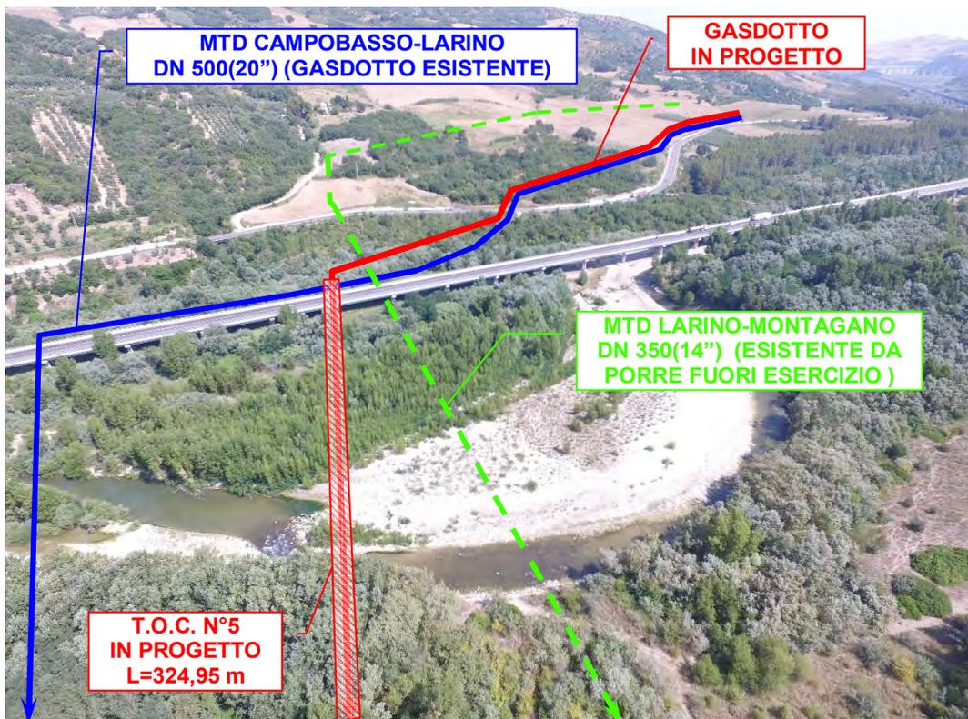
Foto n°30 – Attraversamento Strada Statale n°647 e Fiume Biferno (in Trivellazione Orizzontale Controllata T.O.C. N°5).
