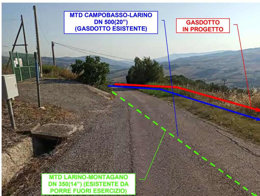
Foto n°73 – 3° Attraversamento con scavo a cielo aperto della Strada Comunale Sferracavallo (asfaltata).
