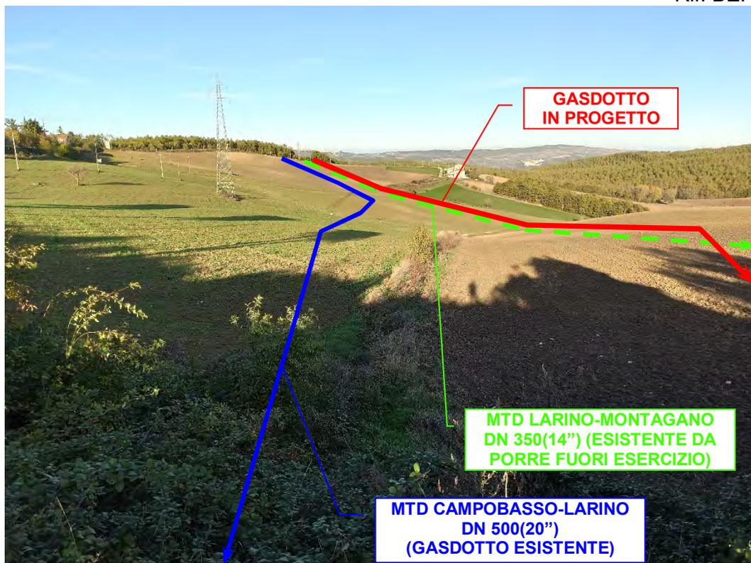
**Foto n°98** – Vista panoramica gasdotto in dismissione (tratto verde), in progetto (tratto rosso) e gasdotto esistente (tratto blu), in località *Piadone Piano*.
