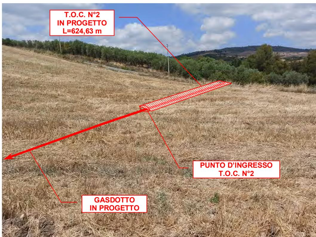
Foto n°10 – Vista del punto d'ingresso T.O.C. n°2, in località Colle delle Forche.
