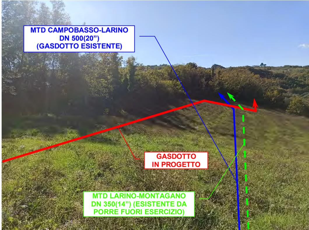
**Foto n°78** – Vista panoramica gasdotto in dismissione (tratto verde), in progetto (tratto rosso) e in gasdotto esistente (tratto blu), prima del 3° attraversamento della *Strada Provinciale n°71*.
