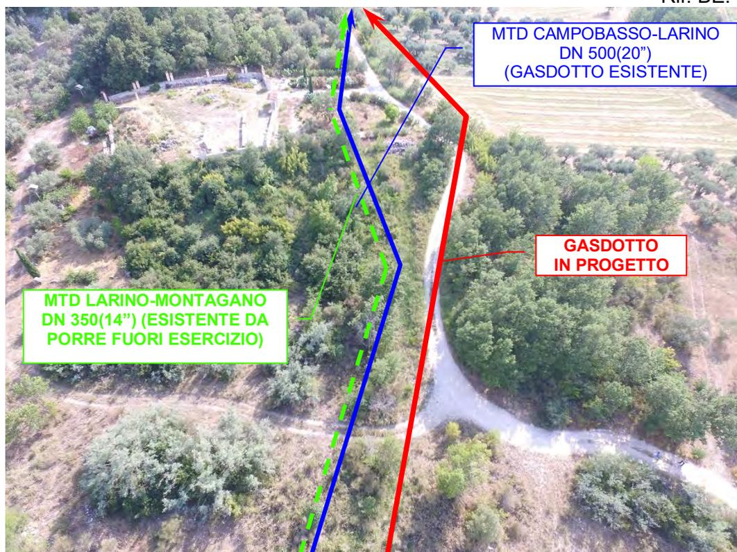
**Foto n°64** – Vista panoramica attraversamento *Strada Comunale Sferracavallo* (sterrata) e gasdotto in dismissione (tratto verde), in progetto (tratto rosso) e in parallelismo con il gasdotto esistente (tratto blu).
