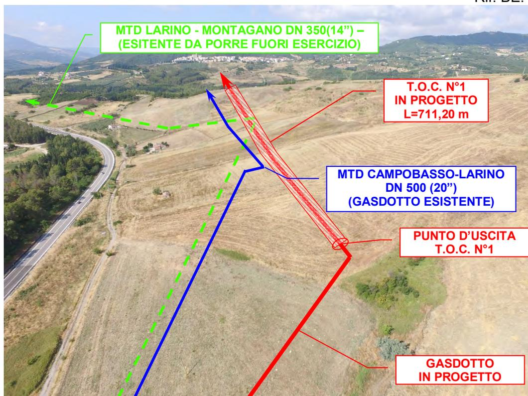
**Foto n°3** – Vista panoramica punto d'uscita T.O.C. N°1 per superamento area di dissesto idrogeologico, in località *Fabbricata*.
