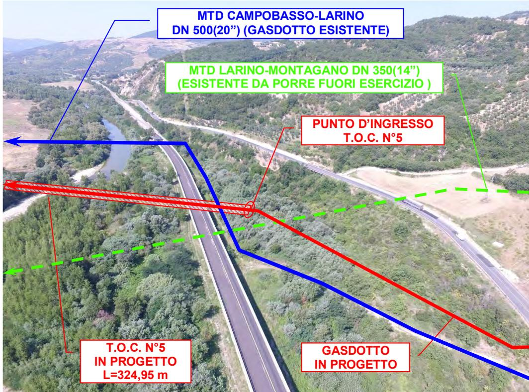
Foto n°29 – Ingresso Trivellazione Orizzontale Controllata (T.O.C. n°5) e attraversamento Strada Statale n°647 e Fiume Biferno.
