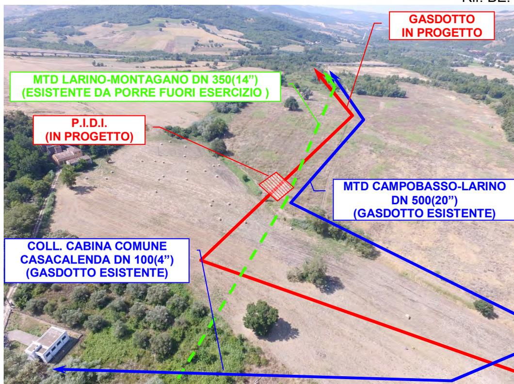
**Foto n°33** – Vista panoramica Punto di Intercettazione di Derivazione Importante (in progetto), di collegamento con il Nodo 640 (esistente).
