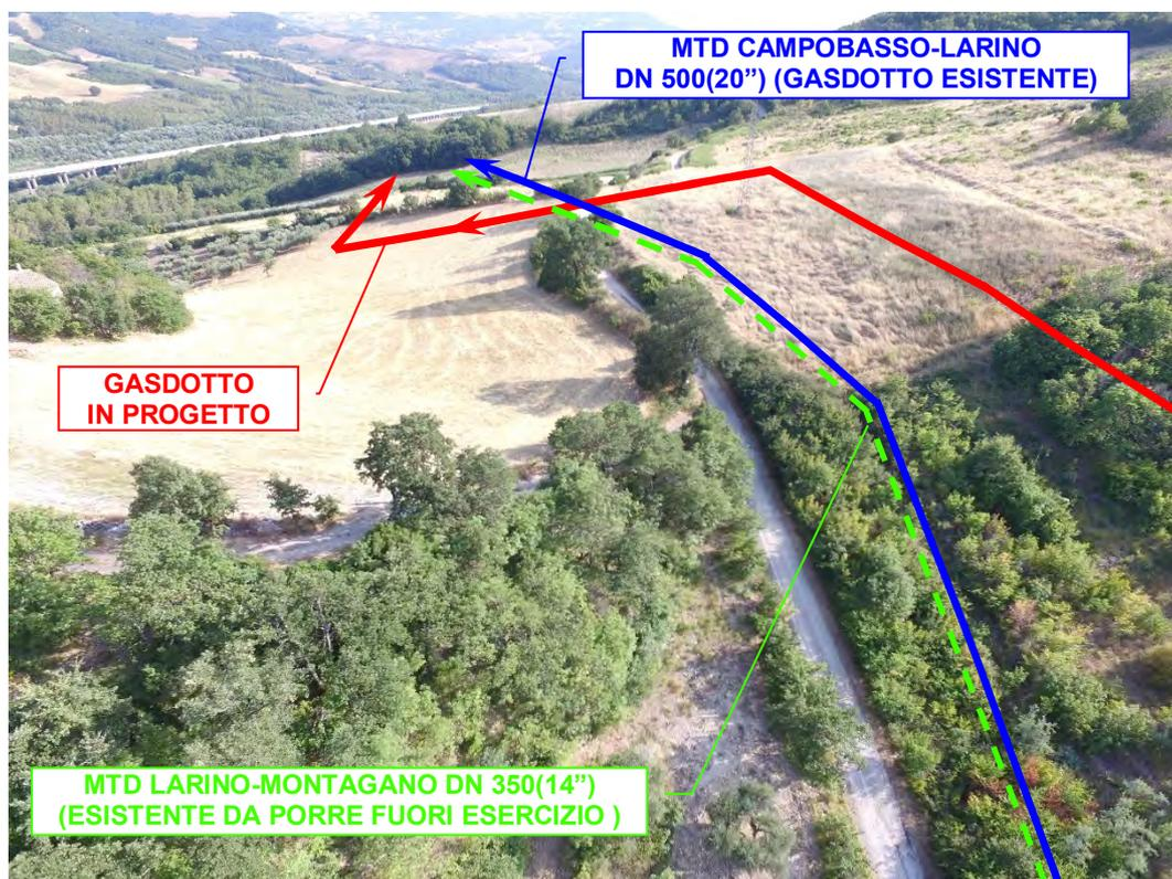
Foto n°20 – Vista panoramica parallelismo con Strada Comunale Guardialfiera-Lupara e con linea elettrica alta tensione.
