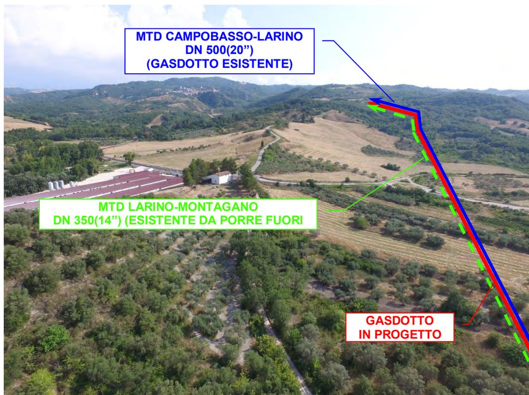
**Foto n°65** – Vista panoramica attraversamenti strada asfaltata e *Strada Vicinale del Mulino* e interferenza della condotta con oliveto in località *Ischia*.
