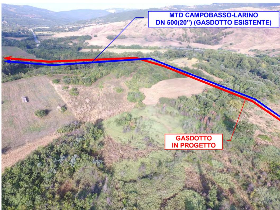
Foto n°56 – Gasdotto esistente e in progetto in parallelismo, in località *Raiale* e attraversamento della strada (identificata catastalmente) come *Strada Comunale Via Ceraso*.
