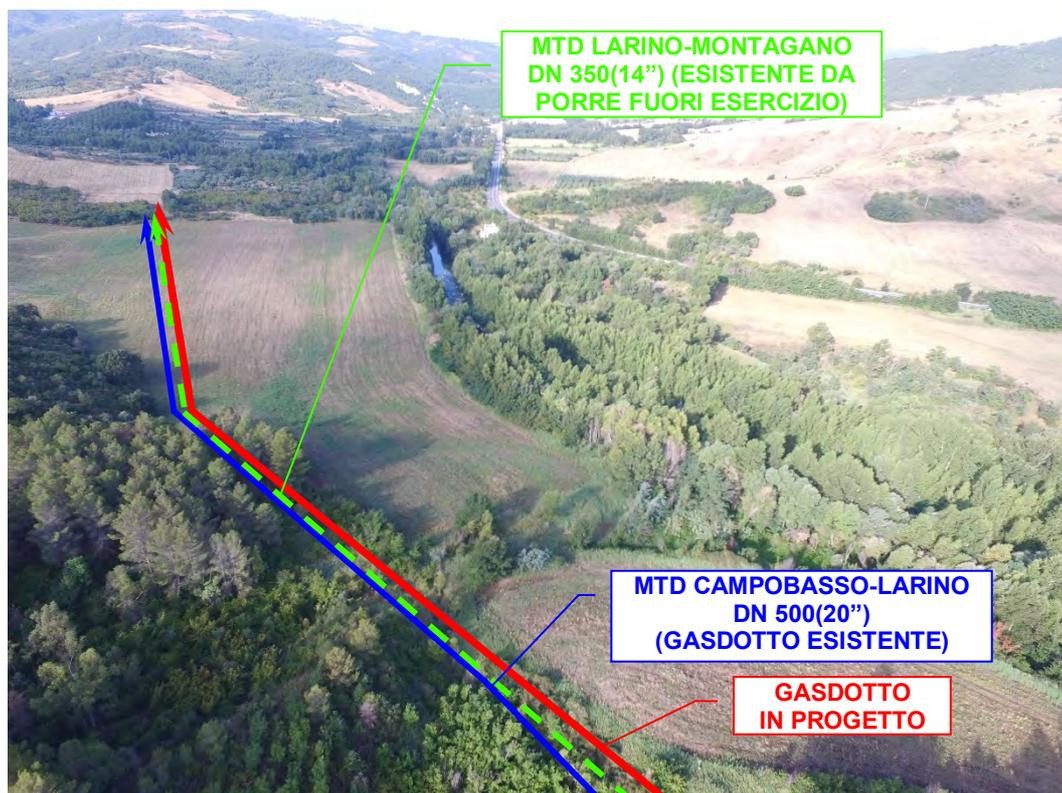
**Foto n°57** – Vista panoramica attraversamento *Vallone D'Aino* e parallelismo dei gasdotti esistenti e in progetto in località *Raiale*, in destra idraulica del *Fiume Biferno*.
