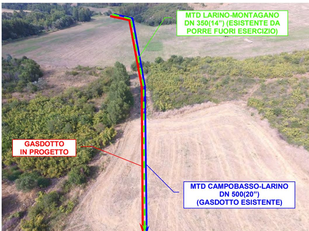
Foto n°59 – Vista panoramica attraversamento *Tratturo Celano Foggia* e parallelismo con gasdotto esistente.
