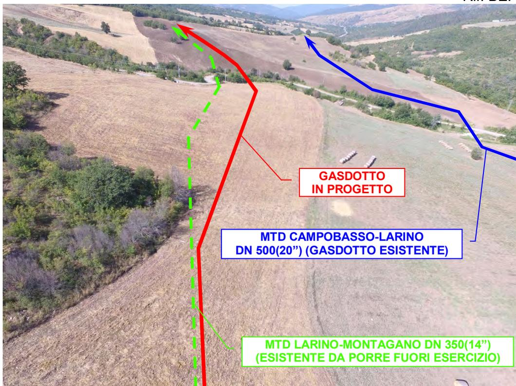
Foto n°49 – Vista panoramica gasdotti esistenti, in progetto e in dismissione in località *Panno Nero*.
