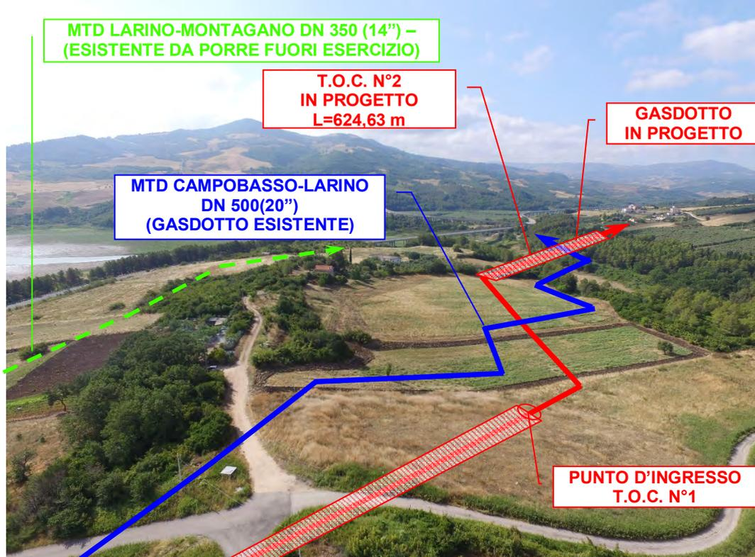
Foto n°5 – Vista degli attraversamenti in T.O.C. (N°1) della Strada vicinale del Molino Palata e Strada Vicinale Vallocchia Ischia del Ponte.
