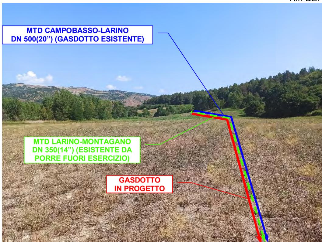
Foto n°58 – Vista panoramica gasdotto in dismissione (tratto verde), in progetto (tratto rosso) e in parallelismo con il gasdotto esistente (tratto blu).
