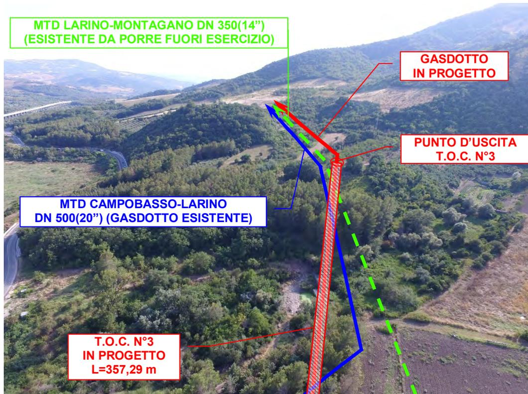
Foto n°17 – Vista panoramica attraversamento Fosso delle Forche con Trivellazione Orizzontale Controllata (T.O.C. N°3).
