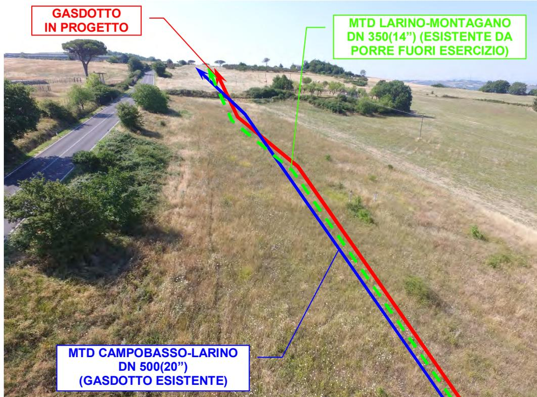
Foto n°86 – Vista panoramica gasdotto in dismissione (tratto verde), in progetto (tratto rosso) e gasdotto esistente (tratto blu), in attraversamento e in parallelismo al gasdotto in progetto.
