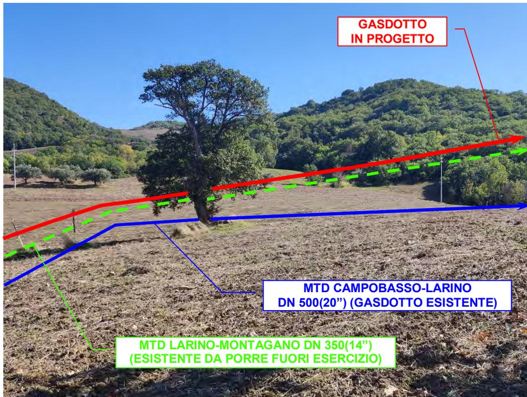
Foto n°42 – Vista panoramica dei gasdotti esistenti e in progetto, in località Valle D'Amico.
