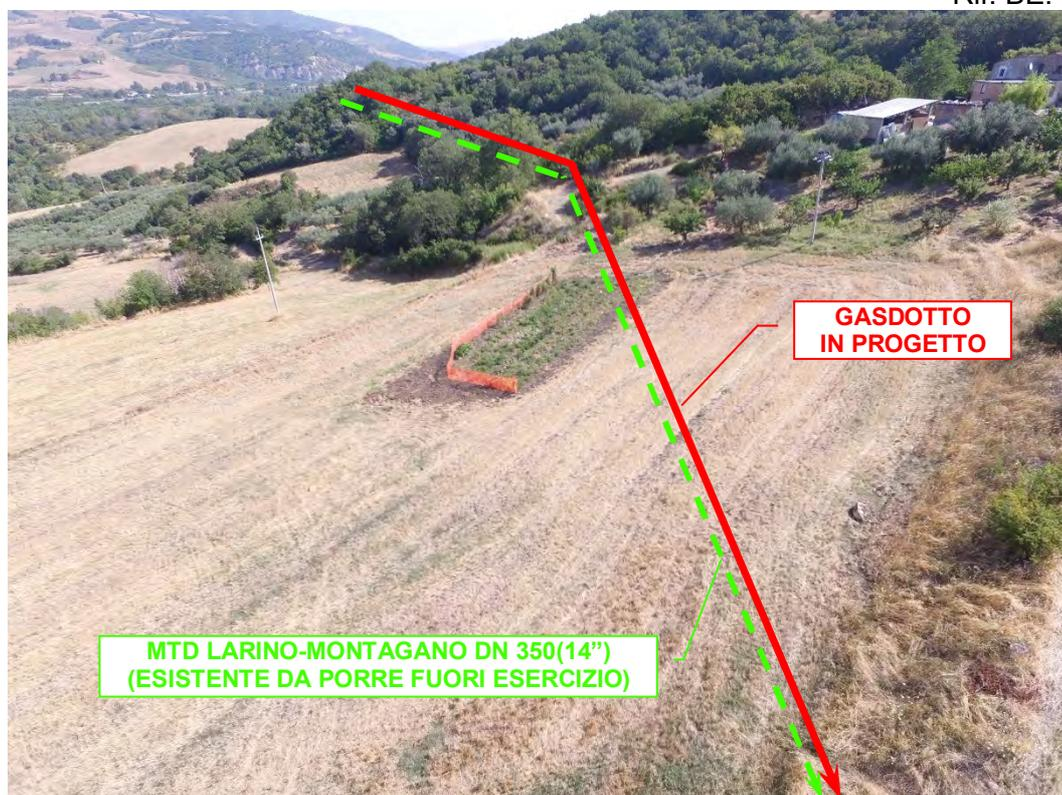
**Foto n°43** – Vista parallelismi gasdotti esistenti e in progetto e Attraversamento della *Strada Vicinale Valle Cupa* (sterrata).
