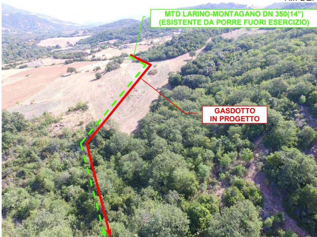
**Foto n°47** – Vista panoramica gasdotto in progetto e in dismissione, prima dell'attraversamento del Fosso Frascarevardo.
