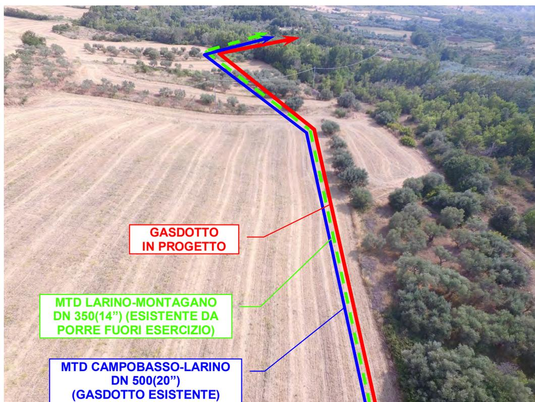
Foto n°61 – Vista panoramica gasdotto in dismissione (tratto verde), in progetto (tratto rosso) e in parallelismo con il gasdotto esistente (tratto blu), in località Palaffio.
