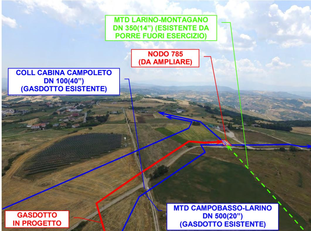
**Foto n°106** – Attraversamento *Strada Comunale Colle Impiso* e Punto di Intercettazione di Derivazione Importante – Nodo 785 da ampliare.
