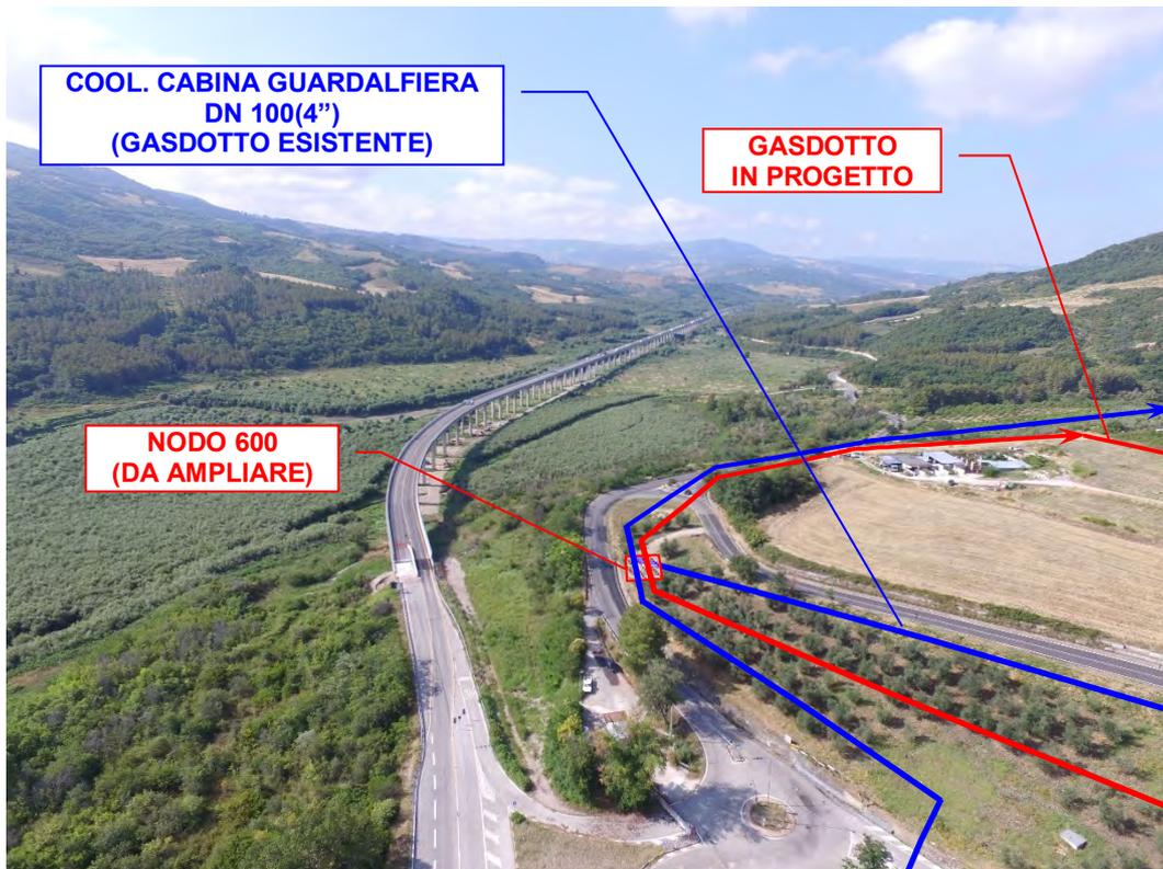
Foto n°11 – Vista panoramica dell'impianto Nodo 600, da ampliare, e attraversamento Strada Provinciale N°73b.
