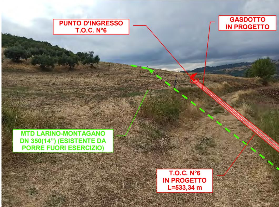
Foto n°53 – Vista panoramica dell'ingresso della Trivellazione Orizzontale Controllata (T.O.C. n°6) e attraversamento *Strada Vicinale Viaco* (sterrata).
