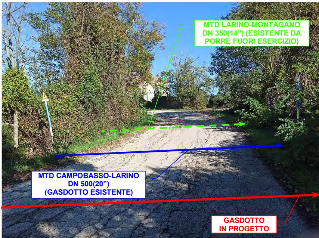
**Foto n°79** – 3° Attraversamento della *Strada Provinciale n°71* con trivella spingitubo.
