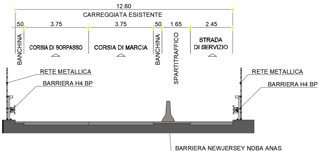
Figura 15 - Sezione tipologica cavalcavia ferroviario oggetto della progettazione
