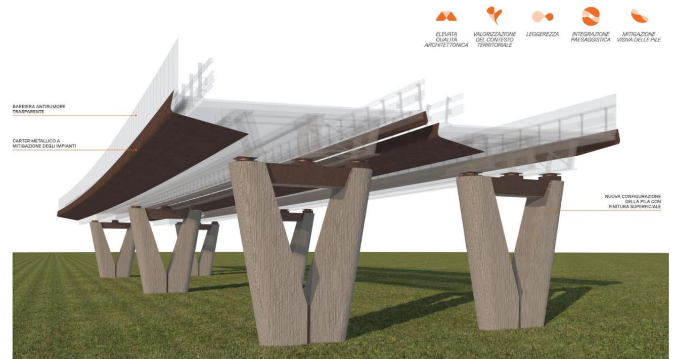
**FIGURA 4-2 PROPOSTE DI OTTIMIZZAZIONE STRUTTURALE DEL PROGETTO ESECUTIVO**
