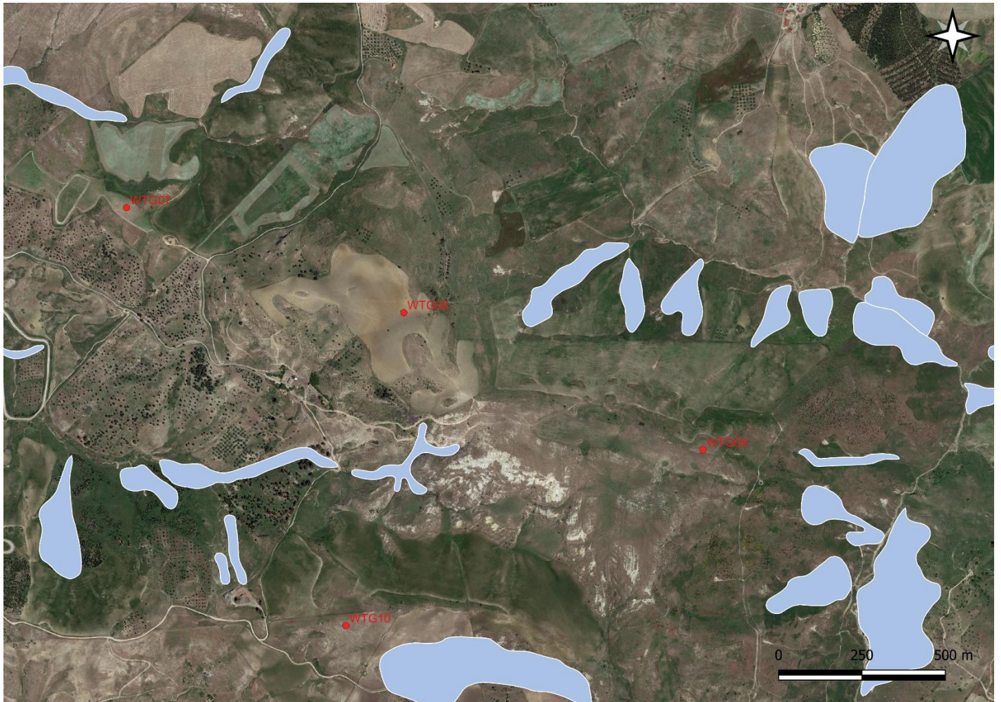
Figura 9- Dissesti censiti settore W area parco (WTG07 -WTG08- WTG09- WTG10)
