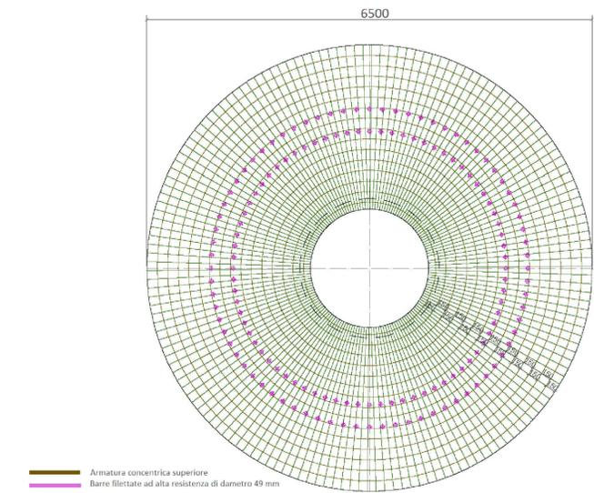
ARMATURA RADIALE SUPERIORE DELLA FONDAZIONE - SCALA 1:100
