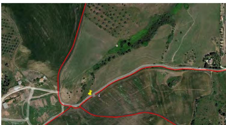
*Figura 147 - Interferenza IB4 relativa al passaggio del cavidotto interrato su strada esistente su area boscata*
