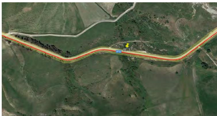
**Figura 144 - Interferenza IB3 relativa al passaggio del cavidotto interrato sulla SP32 con area boscata**
