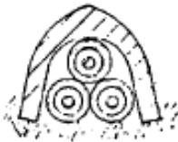
**M** - Cavi direttamente interrati, con protezione meccanica supplementare: lastra piana (M. 1) oppure apposito tegolo (M. 2)
