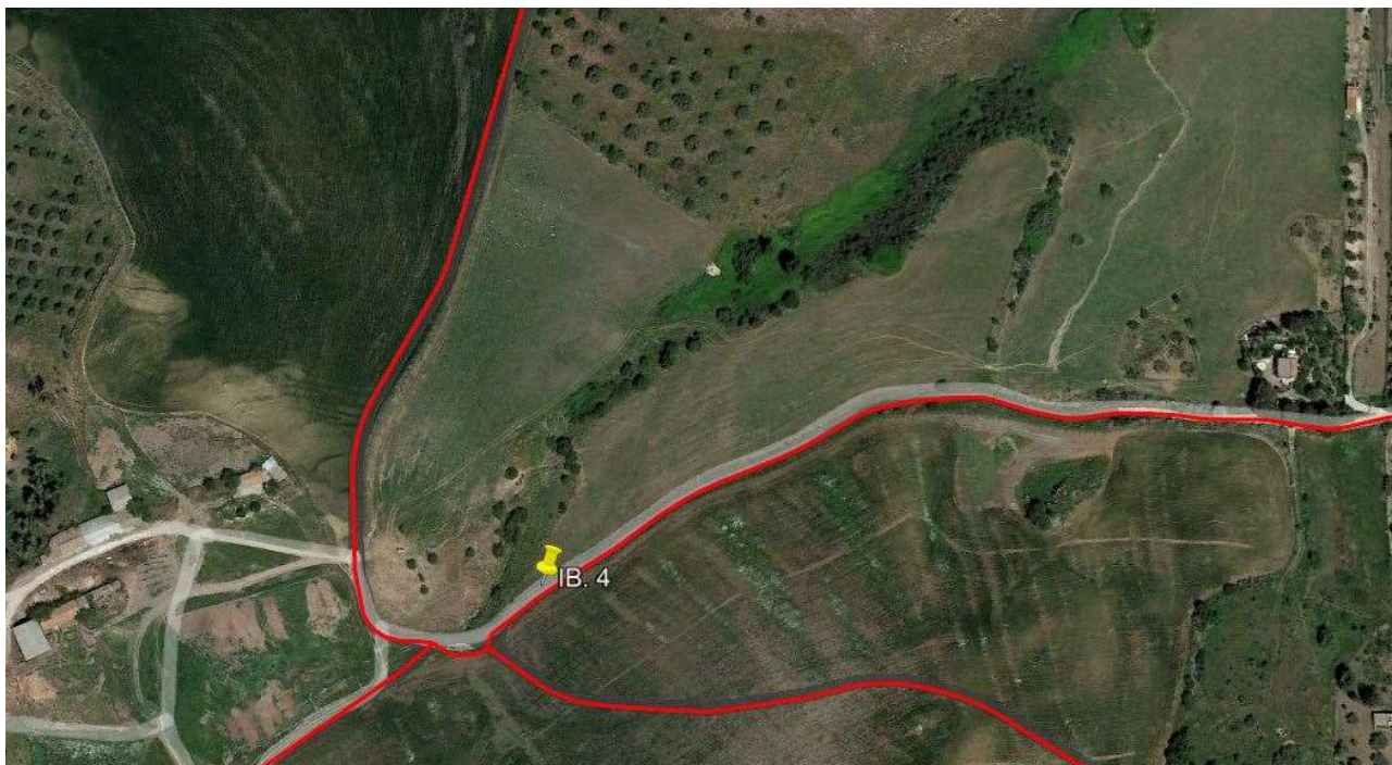
Figura 109 – Interferenza 4 - Passaggio del Cavidotto interrato su strada esistente - Potenziale interferenza con area boscata
