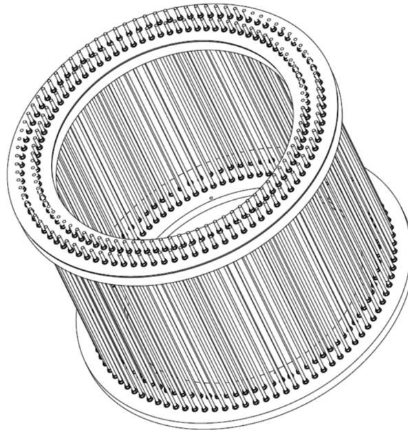
DETTAGLI ANCORAGGIO FLANGE - SCALA 1:10
