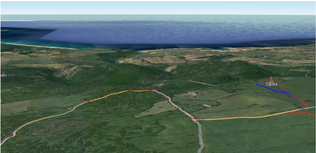
Figura 5.27 – Tracciato in adeguamento, a cui si alternano brevi tratti di nuova costruzione di collegamento alla postazione eolica SE04 (vista verso ovest)
