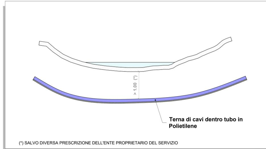
**SEZIONE TIPICA DI INTERFERENZA - Scala 1:20**
