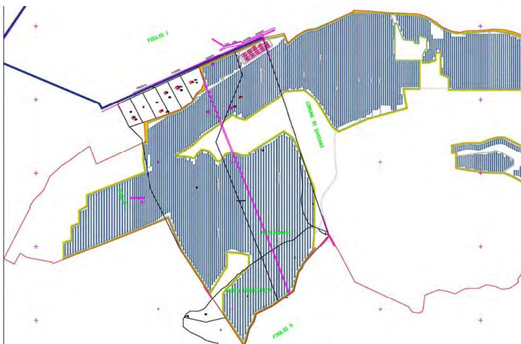
Infine si riporta una ortofoto con inseriti tutti i vincoli e le fasce di rispetto che a seguito dell'analisi vincolistica hanno permesso di individuare quelle aree in cui si poteva posare il generatore fotovoltaico:
