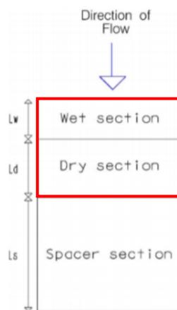
Figura 5.6: Modulo tipo, descrivente il modello concettuale idrologico dell’installazione di strutture fotovoltaiche a tracker su pali infissi comprendente l’area pannelli (in rosso) e l’area di interfila (Fonte: Hydrologic response of solar farm Cook 2013 American Society of Civil Engineers).
