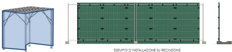
Figura 6.4 – Esempio area destinata al taglio chiusa con pannelli fonoisolanti / fonoassorbenti e di barriera acustica con le caratteristiche richieste: tipo “Rapida F4” CIR Ambiente
