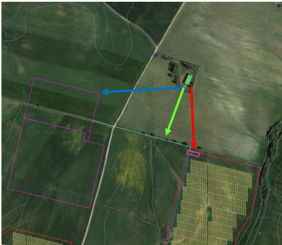
Figura 6.3 – Estratto cartografico con indicazione delle distanze di calcolo dal ricettore R01 (freccia Rossa Area di cantiere, Freccia Blu area SE e freccia verde cavidotto)
