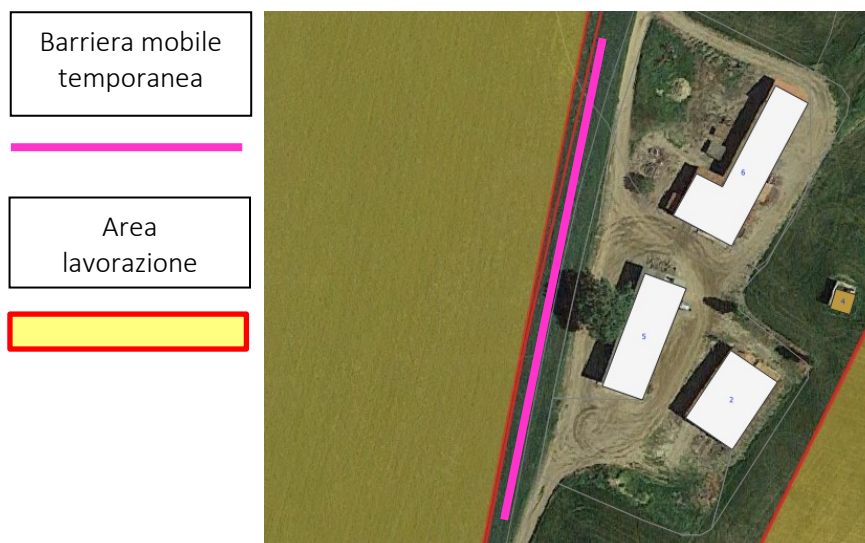
Figura 6.5 – Schema tipo del posizionamento delle barriere – particolare vicinanza di un gruppo ricettori
