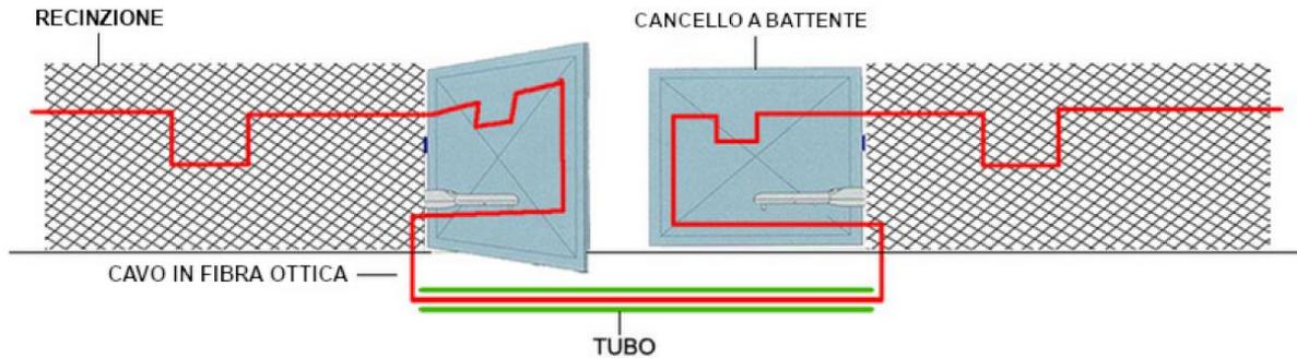
*Figura 4.11 - Schema di installazione cavo in fibra ottica su recinzione.*
