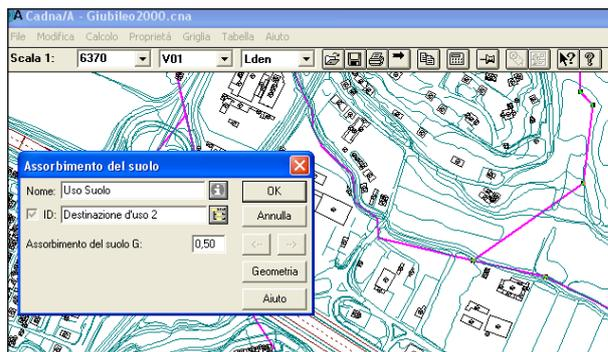
Attraverso la propagazione dei raggi sonori contenenti lo spettro di energia acustica provenienti dalla sorgente, il software tiene conto dei complessi fenomeni di riflessione multipla sul terreno e sulle facciate degli edifici, nonché della diffrazione di primo e secondo ordine prodotta da ostacoli schermanti (edifici, barriere antirumore, terrapieni, etc.).
