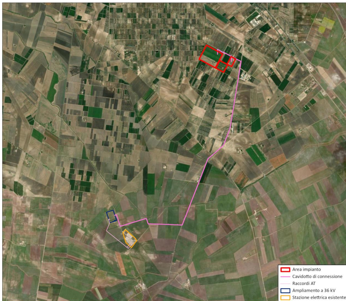
Figura 3.7: Soluzione di Connessione alla SE - In rosa il percorso di connessione dal campo FV (aree rossa) al futuro ampliamento della SE (area blu)
