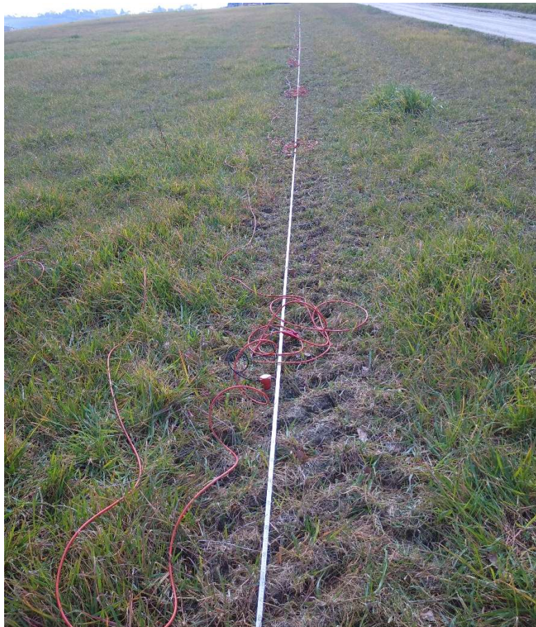
Foto 1 -Particolare esecuzione indagine sismica
