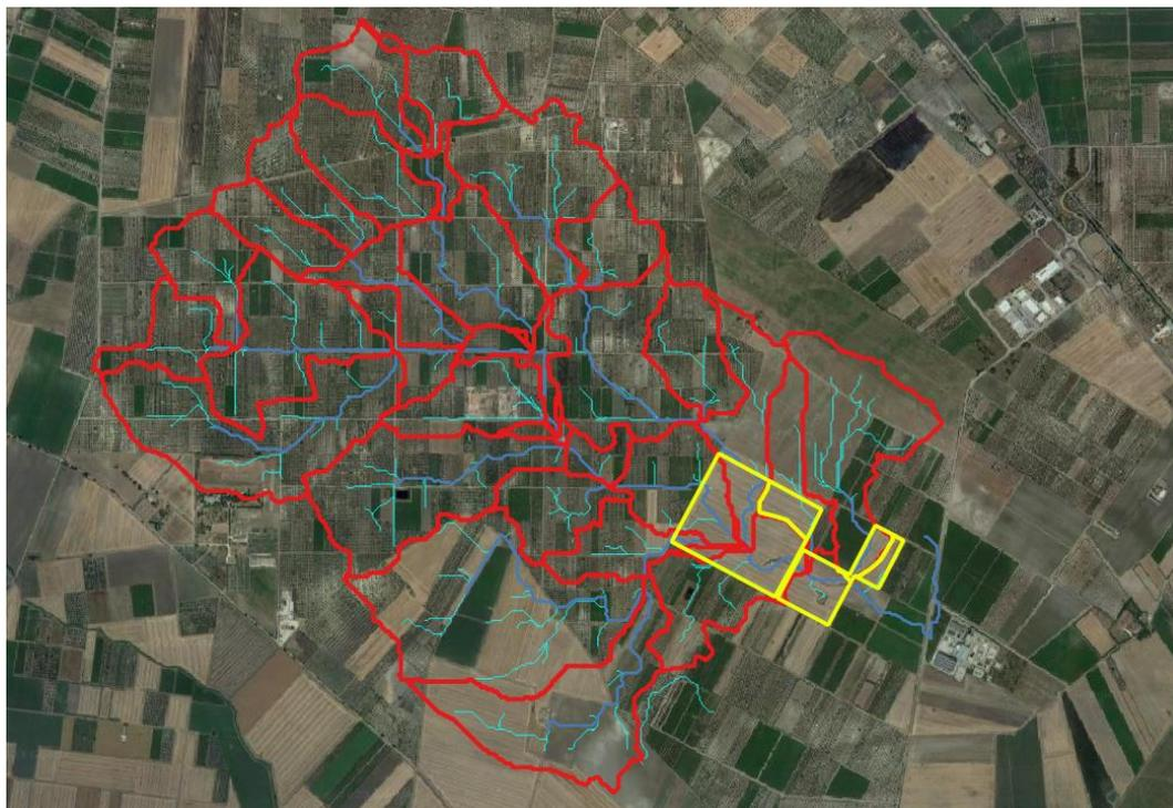
*Figura 6.8: Delimitazione recinzione di impianto con displuviali interni (giallo), rete di drenaggio naturale interna (blu e azzurro) e spartiacque (rosso).*
