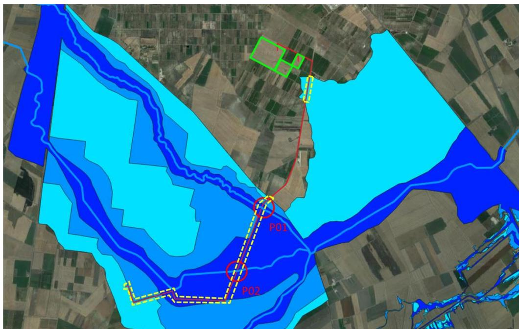
*Figura 5.2: Identificazione punti di interferenza col tracciato del cavo di connessione - Stralcio piano assetto Idrologico (PAI) del bacino Candelaro. Il percorso del cavo di connessione interferisce con fasce di pericolosità alta, media e bassa.*
