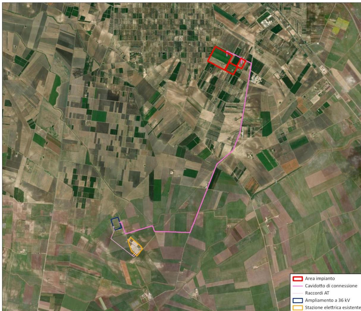
*Figura 4.2: Soluzione di Connessione alla SE - In rosa il percorso di connessione dal campo FV (aree rossa) al futuro ampliamento della SE (area blu)*
