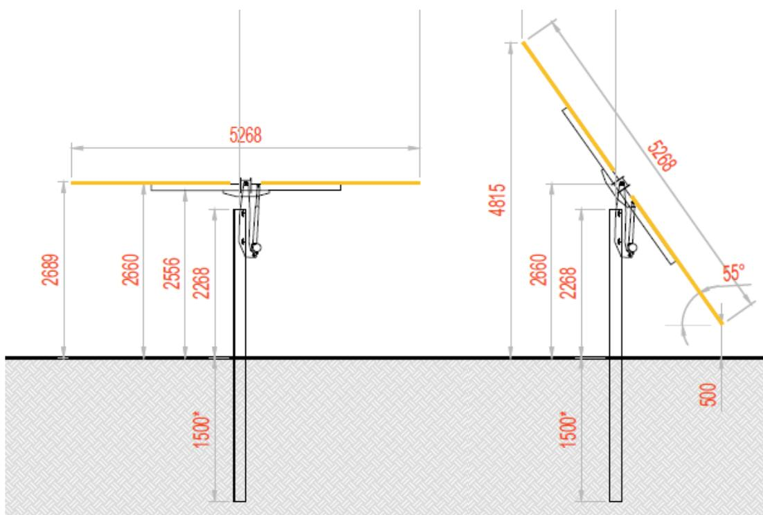
Figura 4.1: Particolare strutture di sostegno moduli, sezione trasversale.
