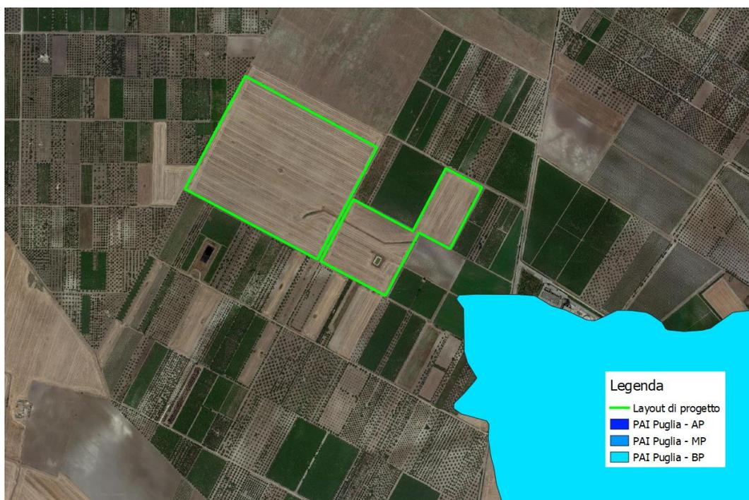
Figura 5.1: Perimetrazione sito, aree interessate dalle fasce di rispetto del vincolo idrografico, idrogeologico ed ulteriori elementi idraulici.
