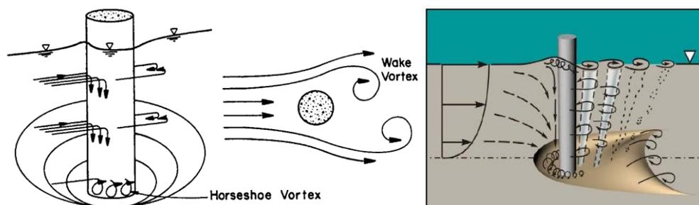
Figura 5.5: Dinamica di erosione in corrispondenza di pile strette (fonte FWHA).
